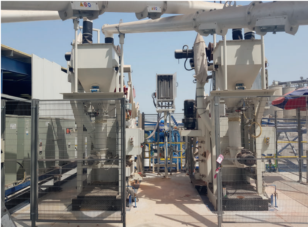
Instalación mezcladora con dos mezcladoras de hormigón bicapa SM400
