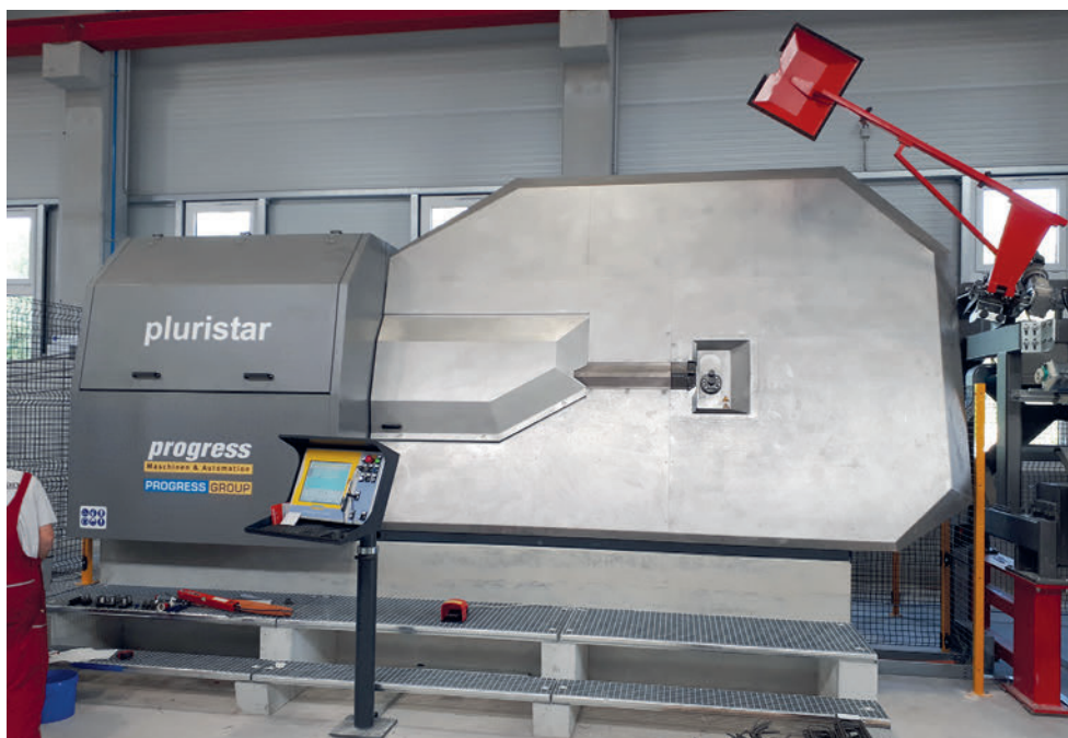
La máquina multifunción Pluristar cuenta con un sistema de cambio automático de procesamiento de alambre doble a simple y un ajuste automático del enderezado.
