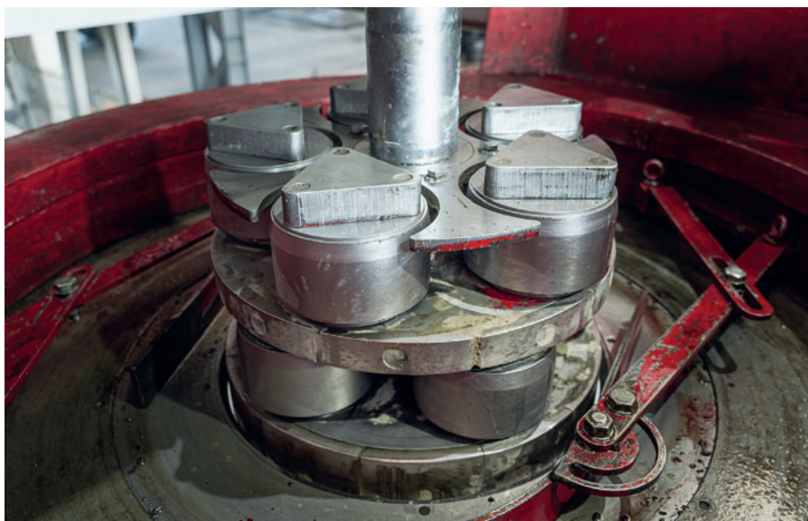
Уплотнительная роликовая головка радиального пресса / замена роликовой головки
