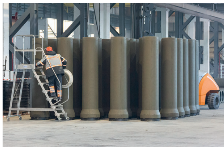
Свежеотформованные бетонные трубы
