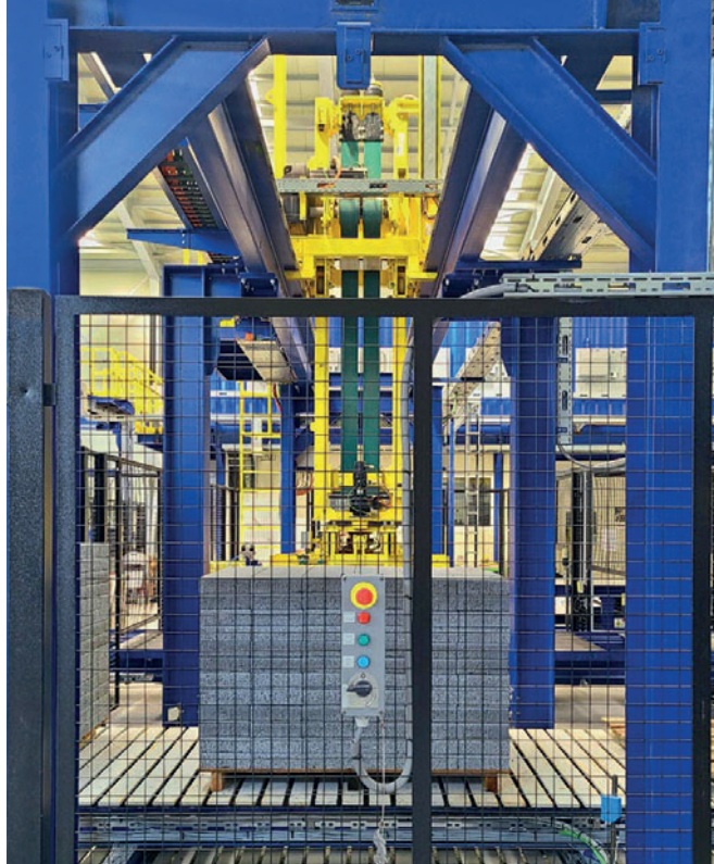
Аккуратная упаковка: полностью электрическая система упаковки известна своим деликатным обращением с бетонными изделиями
