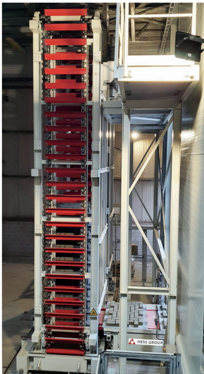
Система подъемников, фото со стороны камеры для выдерживания бетона
