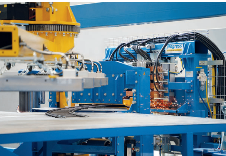
Автомат Tunnel Master оснащен компьютерным управлением для сварки изогнутых тоннельных сегментов
