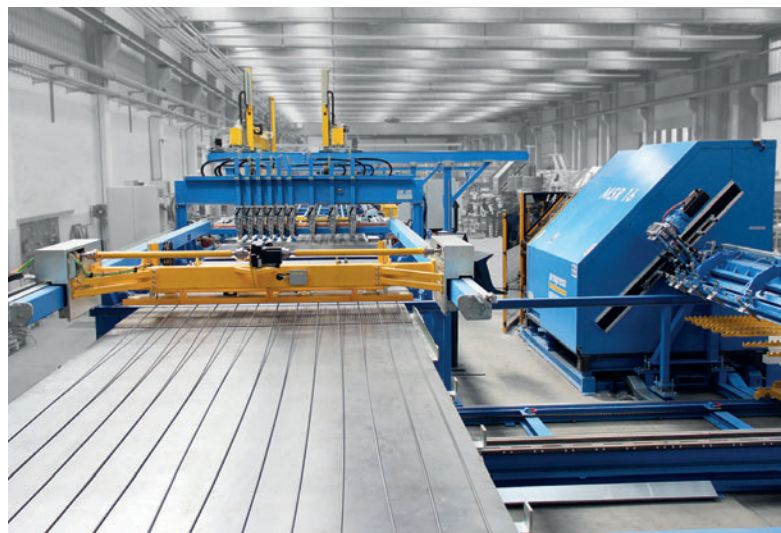
Линия M-System BlueMesh для сварки индивидуальных арматурных сеток
