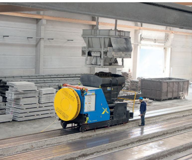
Высокоавтоматизированный экструдер X-Liner FC с шнеками типа «Акулий плавник» гарантирует отличное уплотнение бетона
