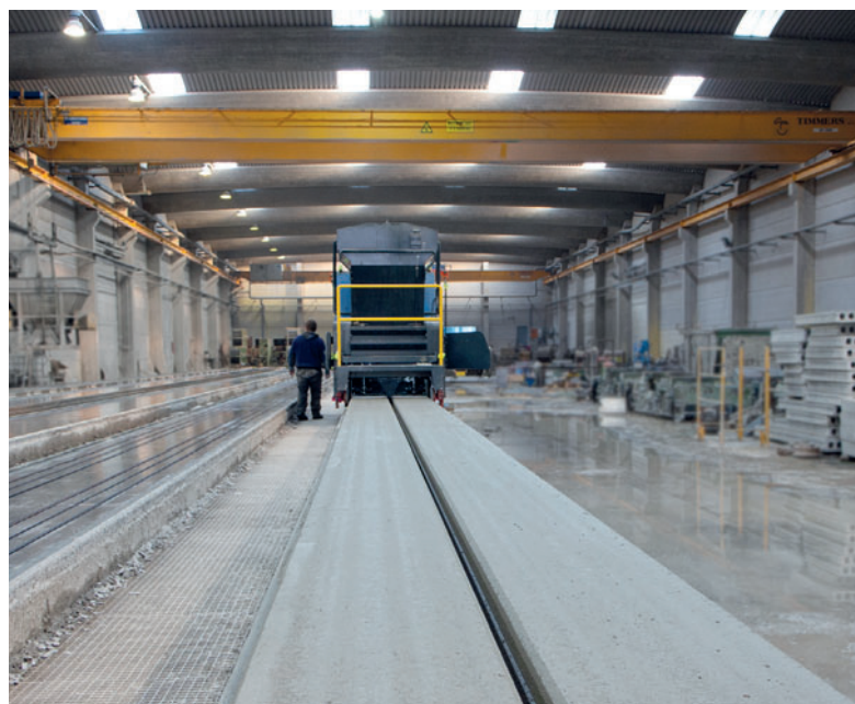
Производственный настил 1,2 м, на котором с помощью экструдера X-Liner одновременно производятся две преднапряженные пустотные железобетонные плиты перекрытия шириной по 60 см
