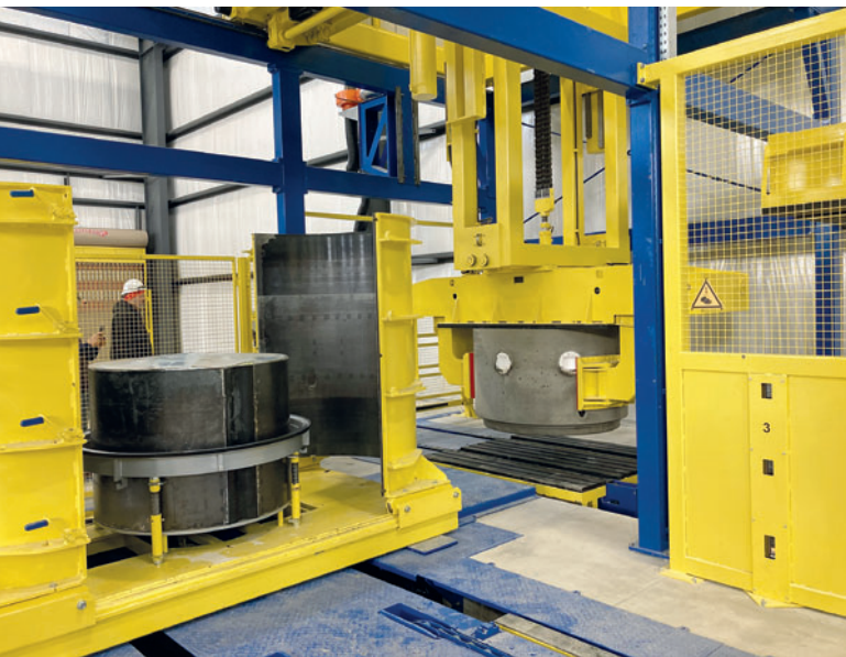
Автоматическая распалубка изделия с оптимизированным временем цикла
