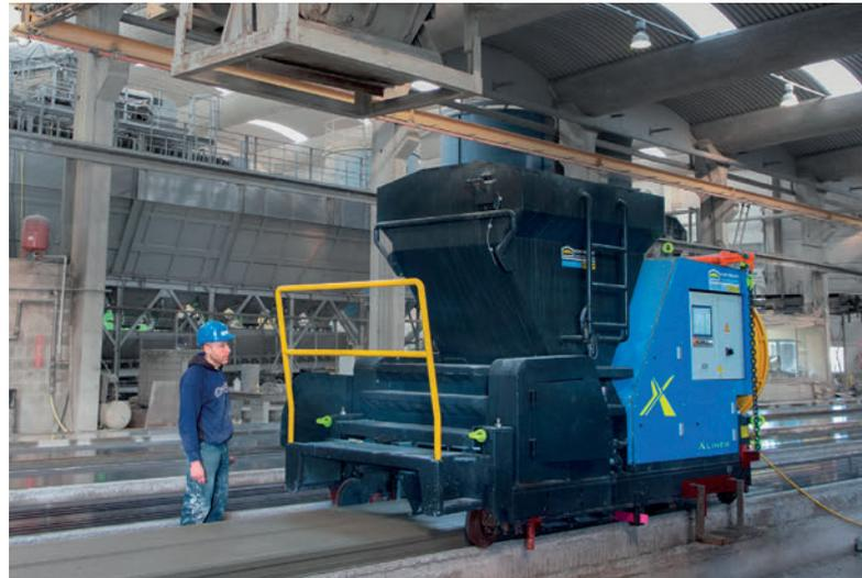
L'estrusore X-Liner richiede l'intervento di un solo operatore per il caricamento del calcestruzzo.
