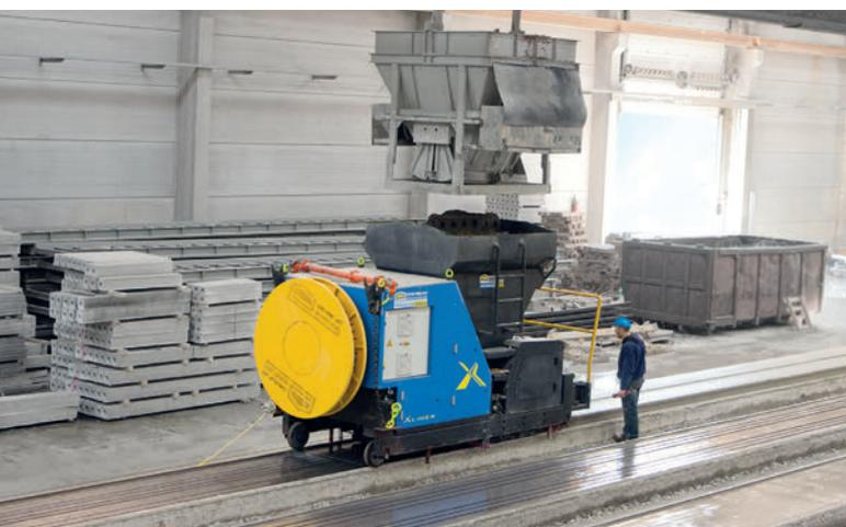
*L'estrusore ad alta automazione X-Liner FC con "coclee a forma di pinna di squalo" garantisce un'eccellente compattazione.*
