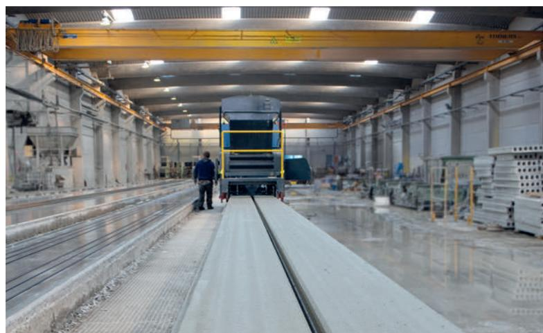
*Pista di produzione di 1,2 m, sulla quale con l'estrusore X-Liner si producono contemporaneamente due solai alveolari di 60 cm di larghezza.*
