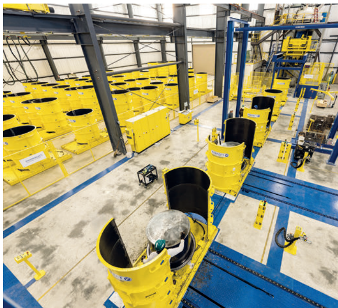
Stampi di facile utilizzo e processi programmati: due pietre miliari per una produzione efficiente di prefabbricati presso Foley
