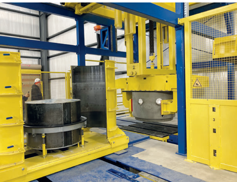
Disarmo automatico e con tempo di ciclo ottimizzato dei fondi per pozzetti
