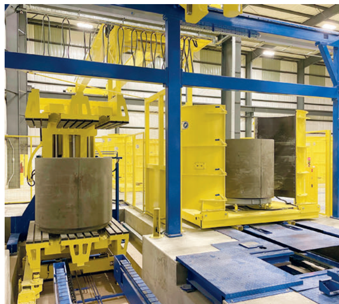
Ove necessario, i prodotti vengono ruotati accuratamente di 180 gradi subito dopo il disarmo.
