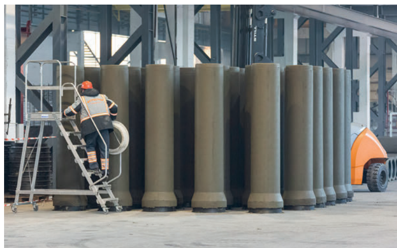
I tubi in calcestruzzo prodotti freschi
