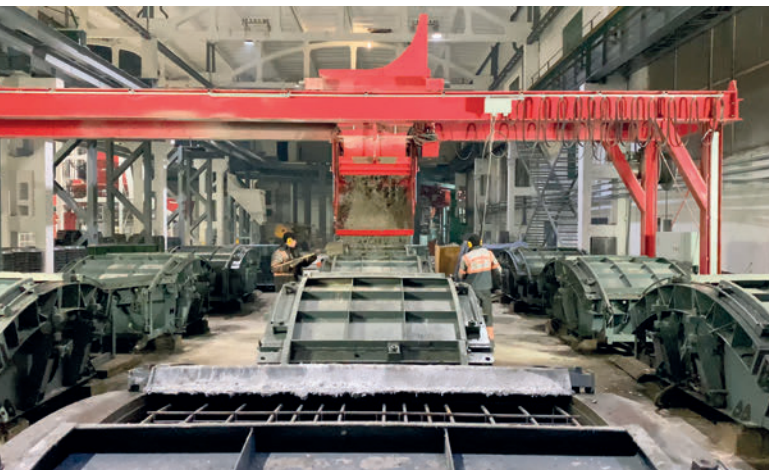
Il nuovo sistema di distribuzione del calcestruzzo per le casseforme per gallerie
