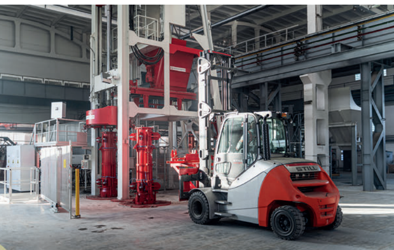
La pressa radiale tipo RP 1230-4 con funzionamento del carrello elevatore a forche
