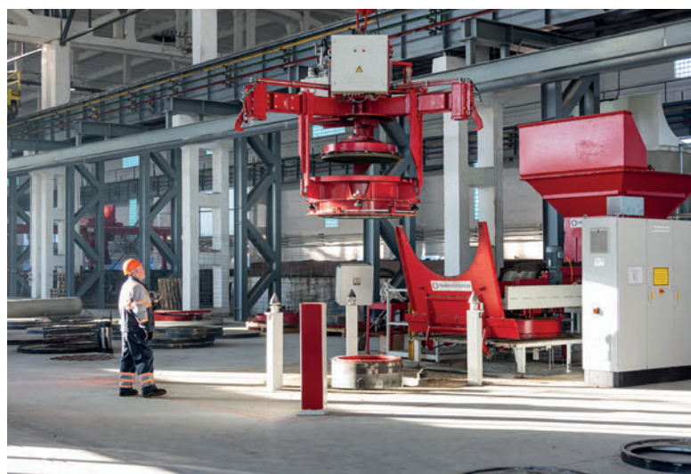
Atlas 150/150 - Produzione di chiusini per pozzetti
