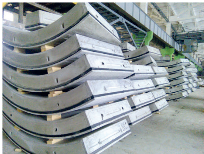
Elementi in calcestruzzo prefabbricati per la costruzione di gallerie
