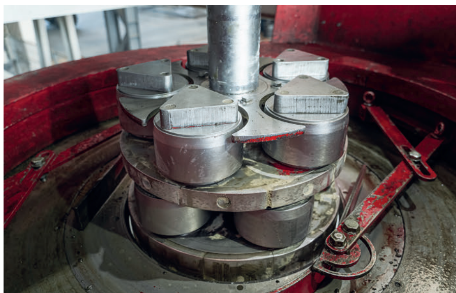
La testa a rulli come strumento di compattazione della pressa radiale / cambio testa a rulli
