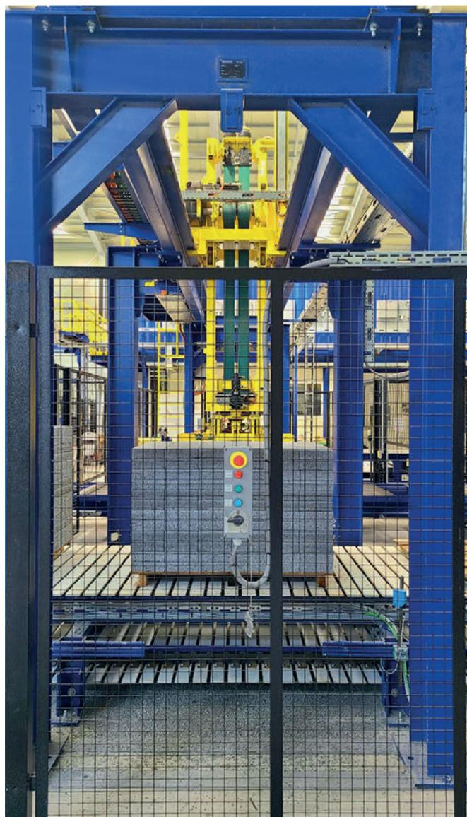
*Pacchi accurati: Il sistema di impacchettamento, completamente elettrico, è noto per una gestione delicata dei prodotti in calcestruzzo.*
