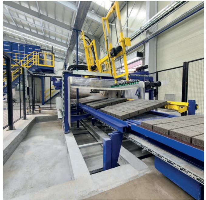
*Impianto di lavaggio a 3 stazioni Masa: I fini degli aggregati nonché il velo di cemento sono rimossi da un processo combinato di spruzzatura e getto d'acqua.*
