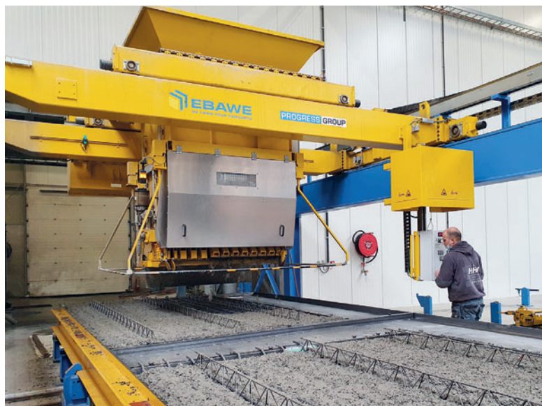
Il distributore di calcestruzzo riempie di calcestruzzo fresco i pallet cassetta dopo aver inserito gli elementi d'armatura realizzati su misura.
