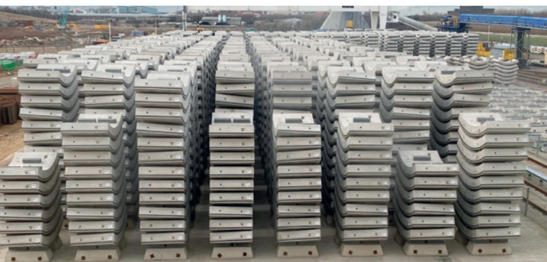
Deposito intermedio dei tubbing - gli elementi prefabbricati gettati per il guscio esterno della galleria
