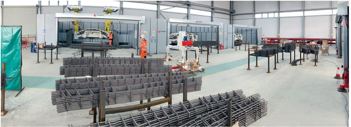
Le reti scalariformi prefabbricate vengono saldate da robot di saldatura (sullo sfondo) con le reti d'armatura, formando la gabbia finita per gli elementi di galleria.
