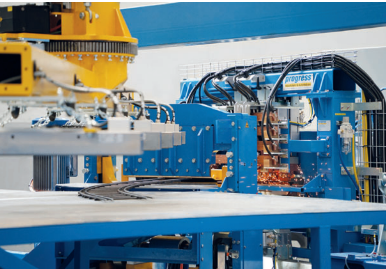
Il Tunnel Master sfrutta un sistema di controllo saldatura computerizzato per produrre segmenti di gallerie curvi.
