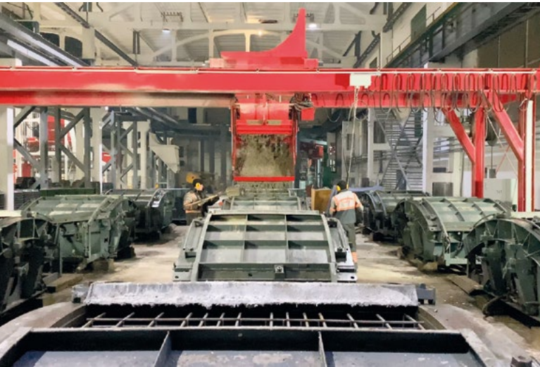
Le nouveau distributeur de béton pour les coffrages de tunnels
