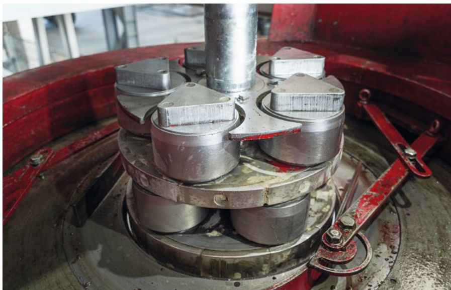
La tête de pressage comme outil de compactage de la presse radiale / remplacement de la tête de pressage
