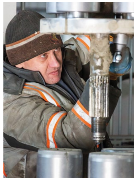
La tête de pressage comme outil de compactage de la presse radiale / remplacement de la tête de pressage
