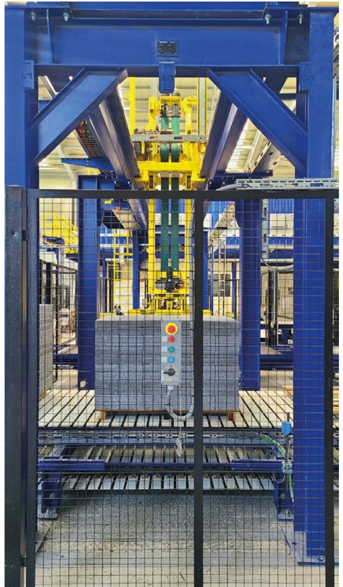
Des paquets précis : le système d'emballage entièrement électrique est connu pour sa manipulation délicate des produits en béton.
