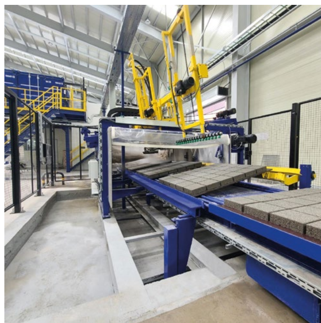
Installation de lavage Masa à 3 stations : les fines des granulats ainsi que la laitance de ciment sont éliminés par un processus combiné de pulvérisation et de rinçage.
