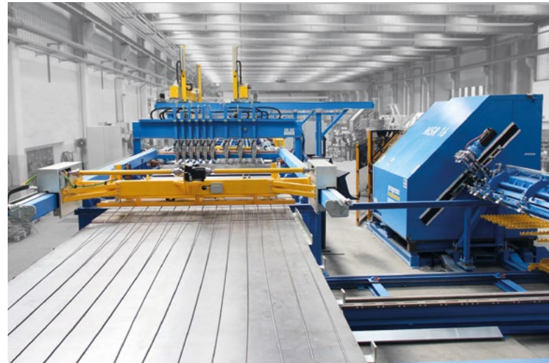
M-System BlueMesh pour la production de treillis soudés personnalisés.
