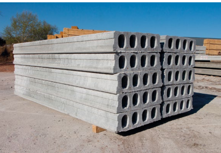
Dalles de planchers alvéolées de 60 cm, très demandées dans le secteur de la construction en Belgique.
