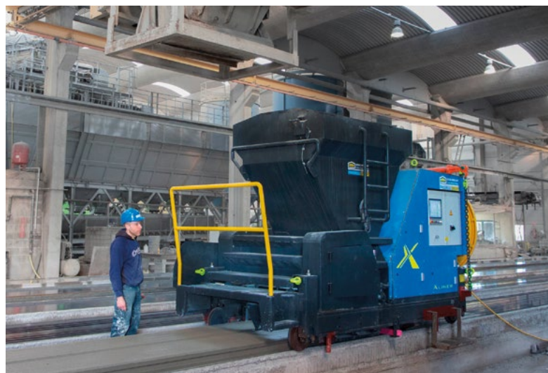
L'extrudeuse X-Liner n'a besoin que d'un seul opérateur pour gérer l'alimentation en béton.
