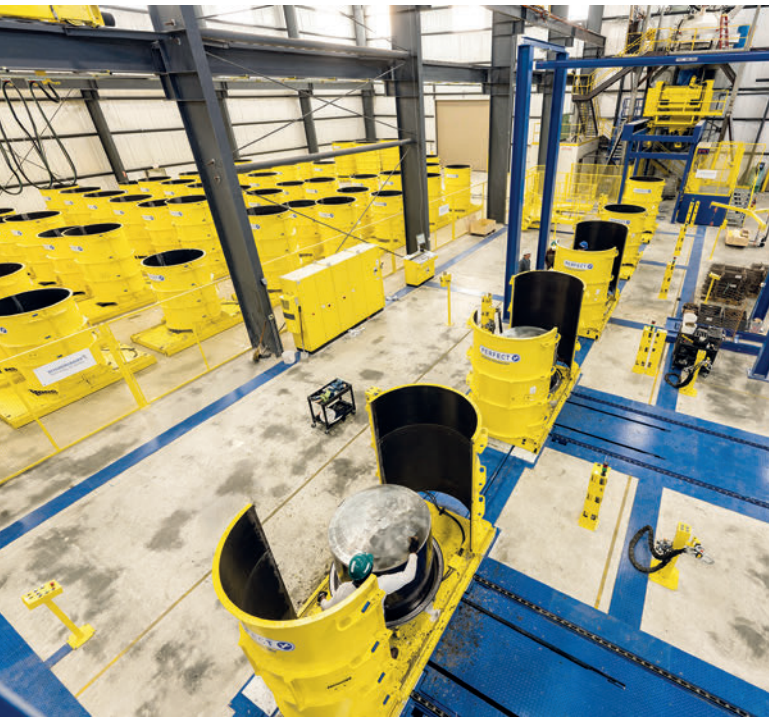
Moldes fáciles de manipular y procesos cronometrados: los dos pilares de la producción eficiente de piezas prefabricadas en Foley
