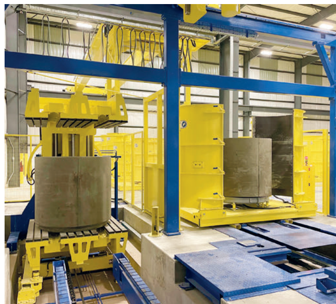
Si es preciso, los productos desencofrados se giran 180 grados de forma automática y, por tanto, cuidadosa.
