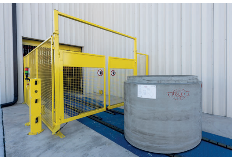
Las bases para pozos se retiran de la nave de producción provistas de una etiqueta individual.
