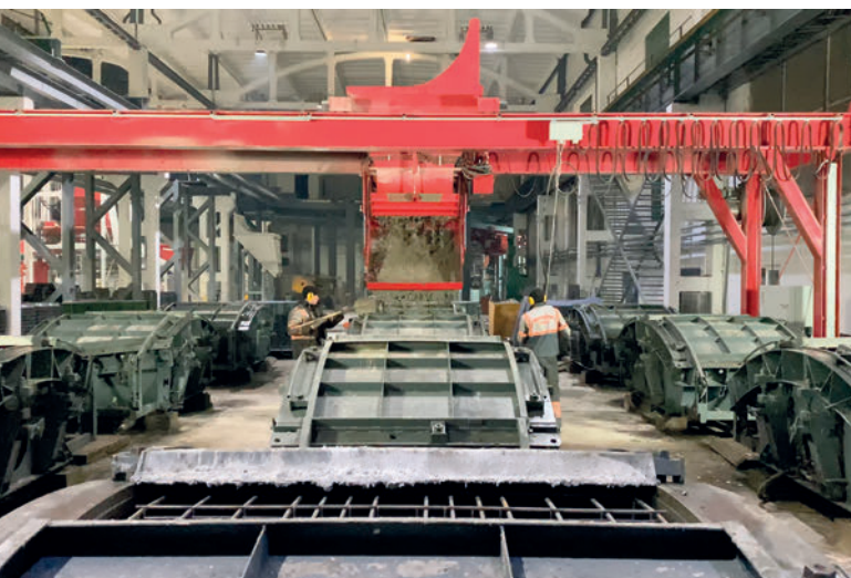
El nuevo sistema de distribución de hormigón para los encofrados de elementos de túnel
