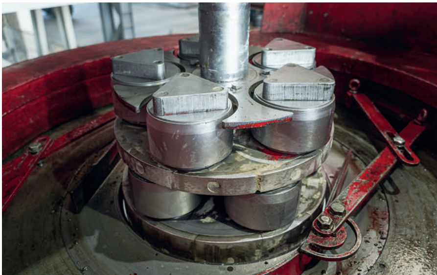
La cabeza prensadora como herramienta de compactación de la prensa radial / sustitución de la cabeza prensadora
