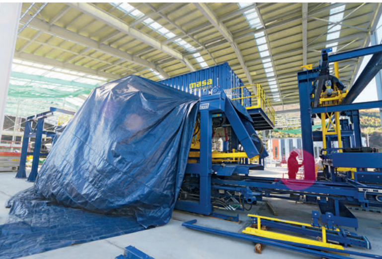
Cubierta: la nueva máquina de producción de bloques de hormigón XL-R de Masa espera a su puesta en marcha.
