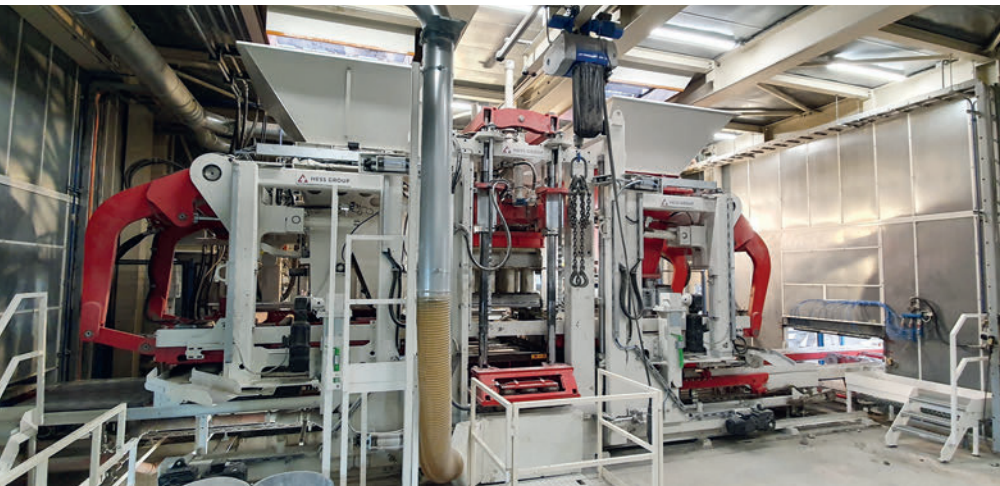
Vista lateral de la máquina de producción de bloques RH 1500-4 MVA
