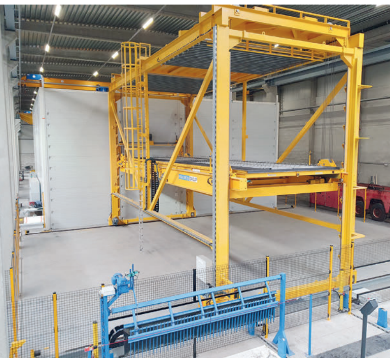
El transelevador para el apilado y desapilado automáticos de bandejas se controla a través del programa ebos®
