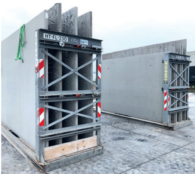
Elementos de muro doble listos para transportar a la obra
