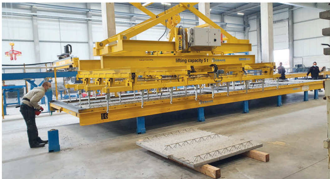
El travesaño de elevación permite retirar los elementos con cuidado
