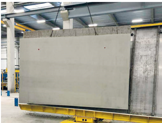
Producción de los primeros elementos de muro doble
