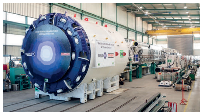
La tuneladora S-1175 de Strabag AG.
