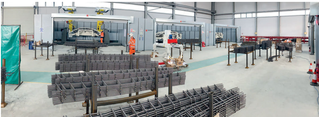
Los robots de soldadura (se aprecian en segundo plano) sueldan las escaleras prefabricadas a las mallas de armadura formando una jaula lista para elementos de túnel.
