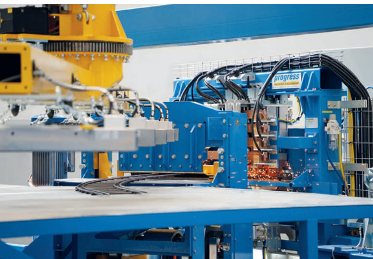
La Tunnel Master utiliza un sistema de control de soldadura informatizado para fabricar segmentos de túnel doblados.
