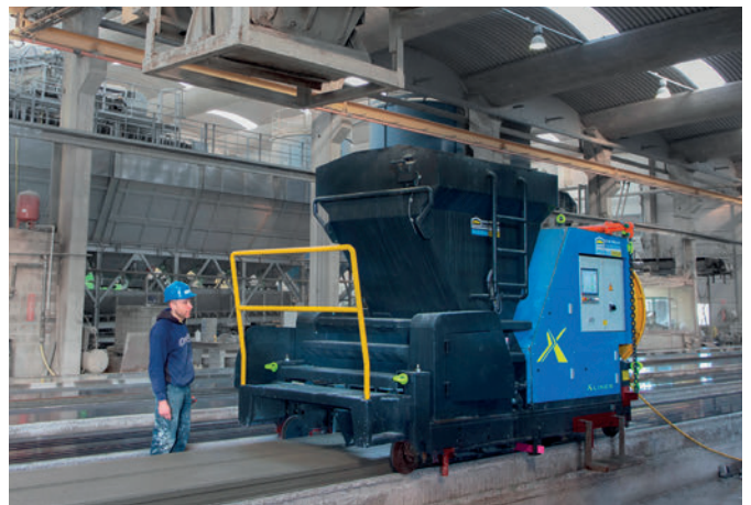
La extrusora X-Liner, de G&J Industries, solamente necesita un operario para el abastecimiento del hormigón
