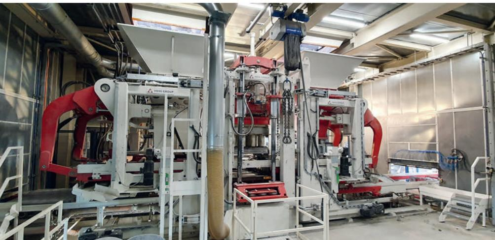
Seitenansicht Betonsteinmaschine RH 1500-4 MVA
