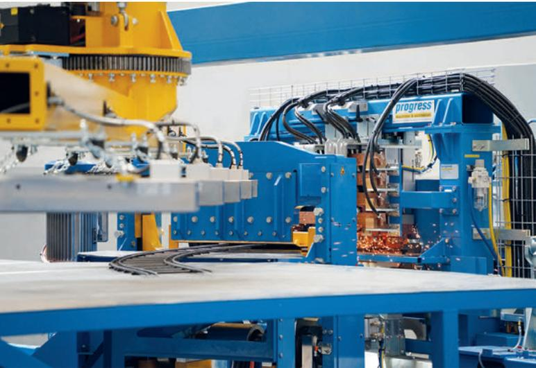
*Der Tunnel Master nutzt eine computergesteuerte Schweißsteuerung zur Herstellung von gebogenen Tunnelsegmenten.*
