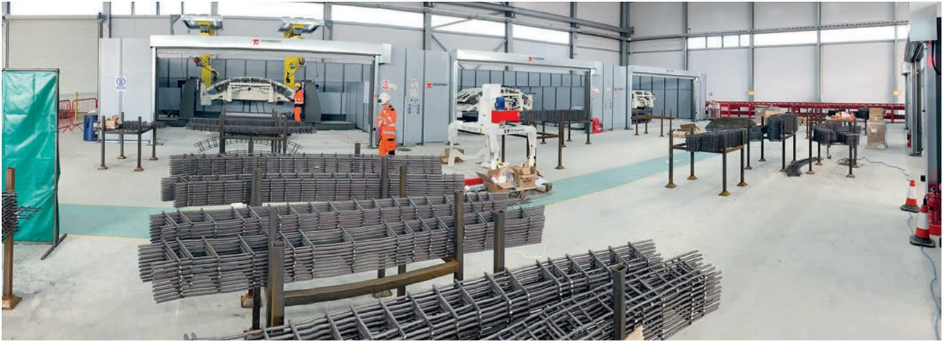
Die vorgefertigten Leitern werden von den Schweißrobotern (im Hintergrund sichtbar) mit den Bewehrungsmatten zum fertigen Korb für Tunnelelemente zusammengeschweißt.
