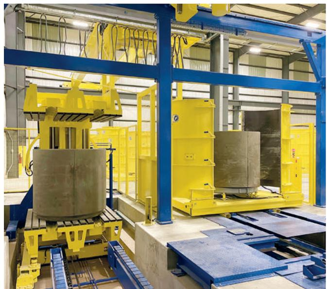
*Entschalte Produkte werden bei Bedarf automatisch und damit schonend um 180 Grad gewendet.*
