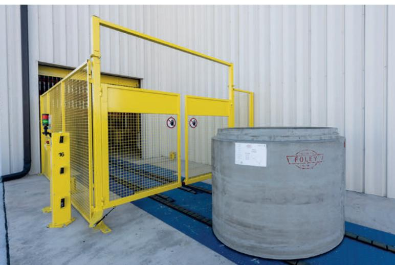
*Mit individuellem Label versehen werden die Schachtböden aus der Fertigungshalle gefahren.*
