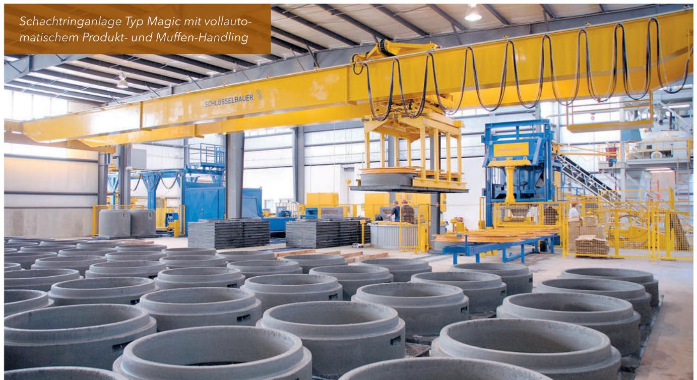
*Schachtringanlage Typ Magic mit vollautomatischem Produkt- und Muffen-Handling*
