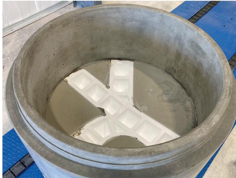
*Effiziente Herstellung monolithischer Betonschachtunterteile*
