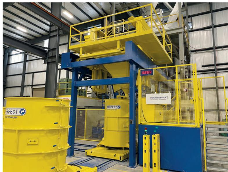
Durch das arbeitsteilige Rüsten der Formen werden stetig Formen zum Befüllen mit SVB bereitgestellt.
