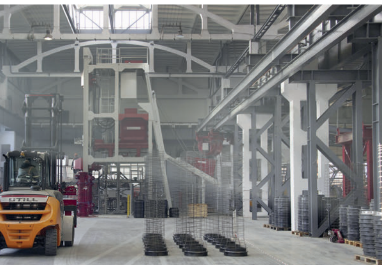
Betonrohr-Produktion mit der Radialpresse bei Betonwerk Minskmetrostroy
