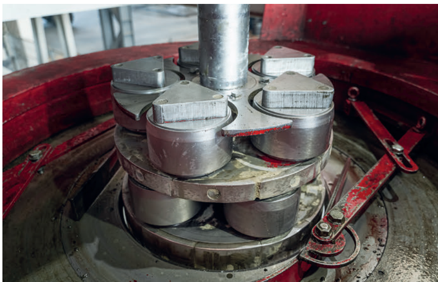
Der Rollenkopf als Verdichtungswerkzeug der Radialpresse/Rollenkopfwechsel
