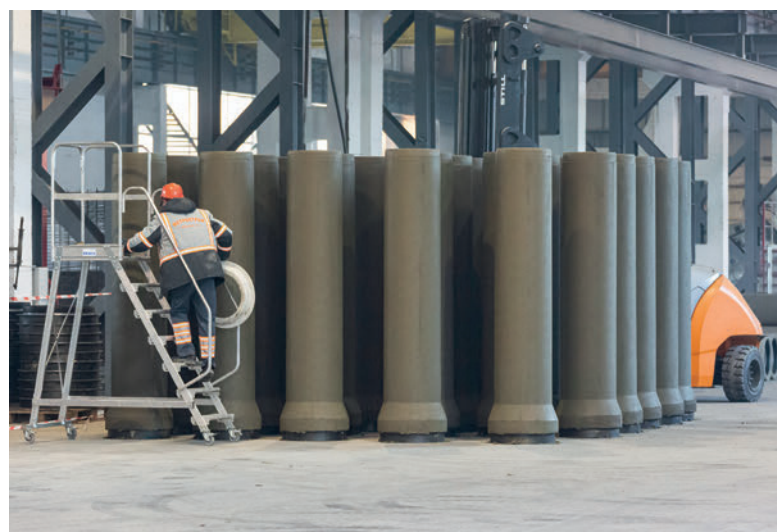
Die frisch produzierten Betonrohre
