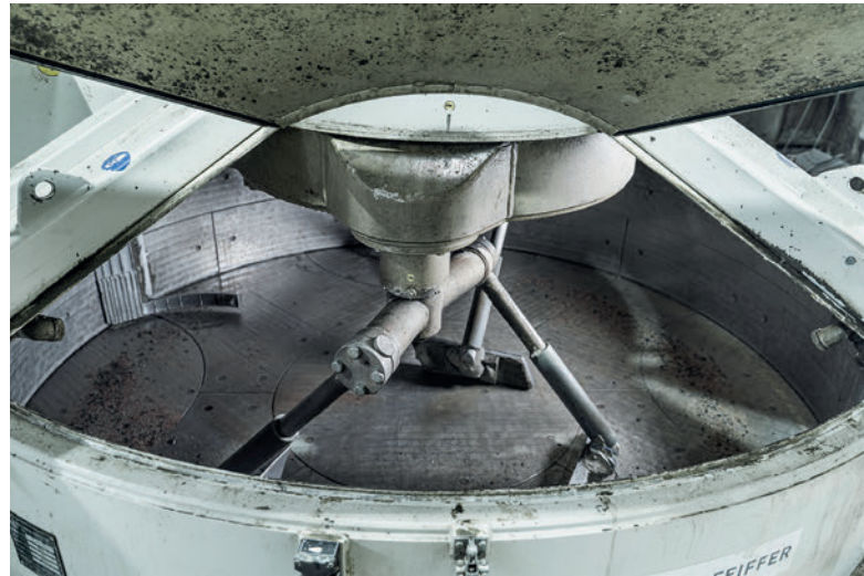
Durch große Wartungsklappen ist der Mischer leicht zugänglich.
