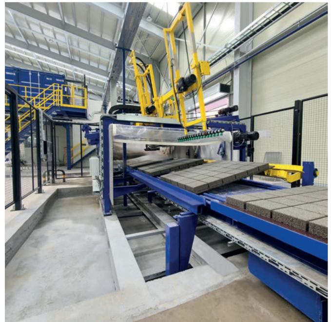
*Masa-3-Stationen-Auswaschanlage: Feinanteile der Zuschlagstoffe sowie der Zementschleier werden durch einen kombinierten Sprüh- und Schwallprozess entfernt.*
