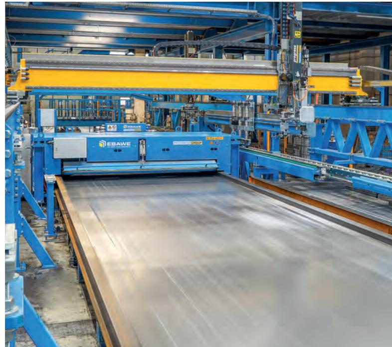
Устройство для очистки поддонов Ebaawe также является частью нового опалубочного робота
