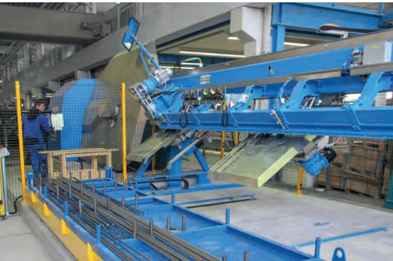
В эксплуатации на заводе Schwörer Bausysteme GmbH с начала 2021 года: Pluristar – многофункциональная машина для всех этапов обработки арматурной стали с бухты
