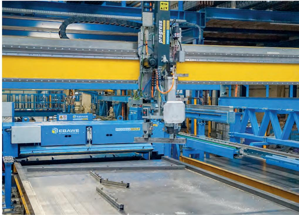
Распалубочный робот в полностью автоматическом режиме снимает опалубочные профили перед подачей поддонов на станцию очистки
