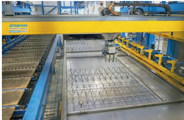
Арматурная линия Wire Center укладывает поперечную арматуру с распорками и без них, а также продольную арматуру и решетчатые фермы в соответствии со спецификациями САПР
