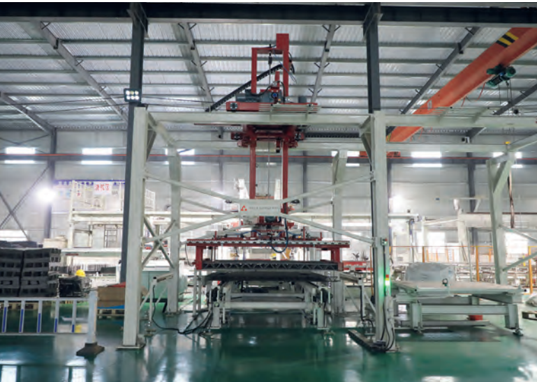
Рисунок 11: Система паллетирования с точными датчиками положения для эффективного перемещения стальных балок
