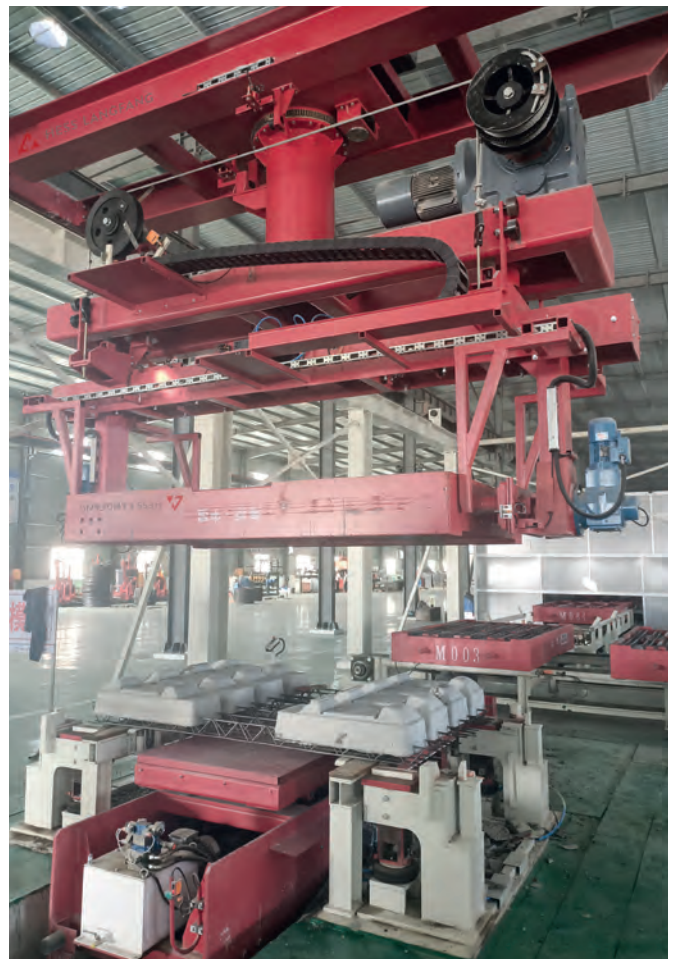
Рисунок 5: Система распалубки с устройством поворота формы и столом для распалубки
