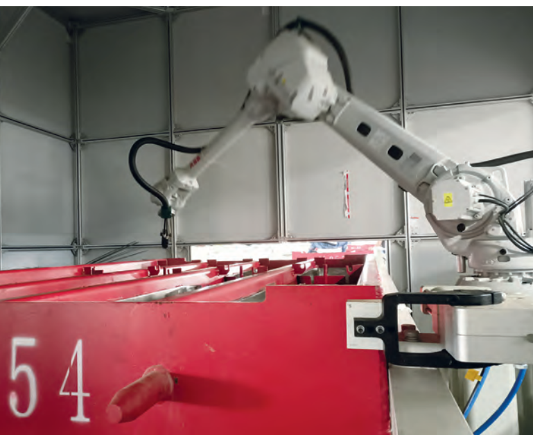
Рисунок 13: Распыление смазки с помощью роботов
