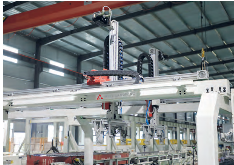
Рисунок 8: Автоматизированная станция установки арматуры
