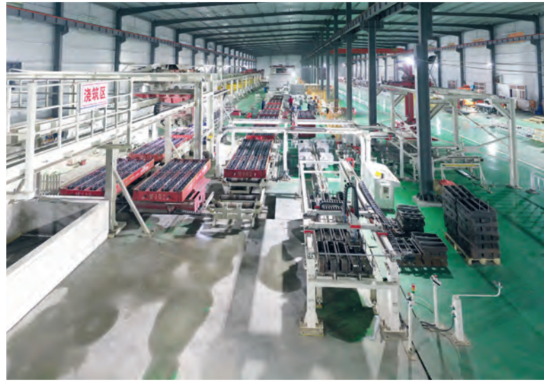
Рисунок 12: Полностью автоматизированная укладка закладных
