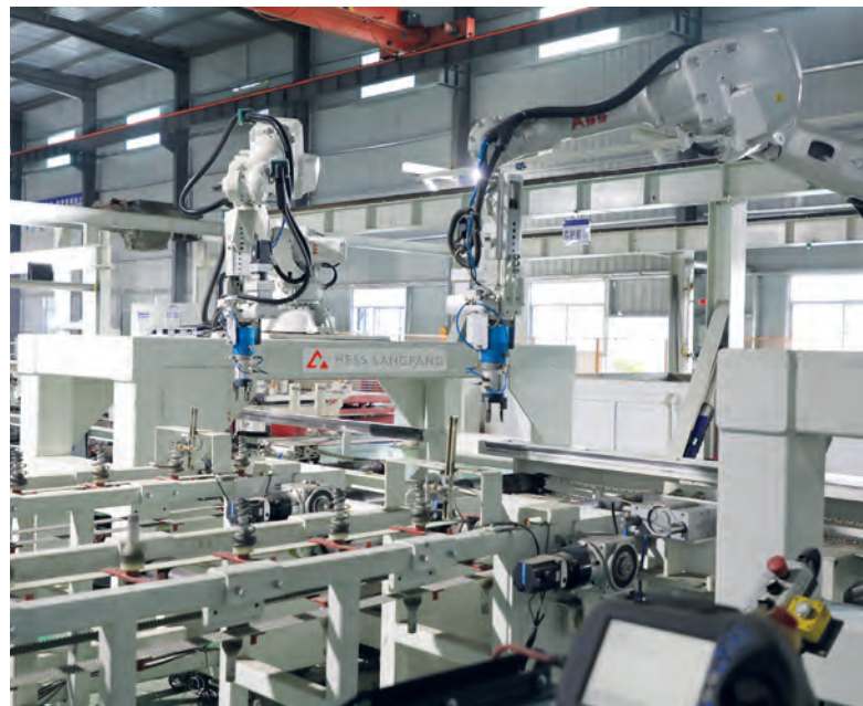
Рисунок 9: Полностью автоматизированная установка пружинных элементов в пресс-формы для железнодорожных шпал
