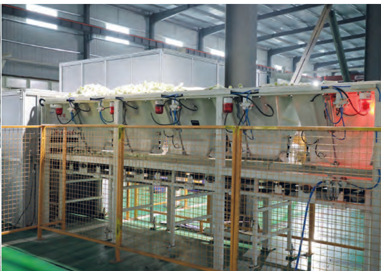
Рисунок 10: Система подачи анкеров для автоматической установки роботами
