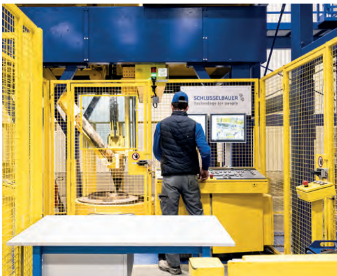
Процессы заполнения, а также погрузки и выгрузки форм из многоярусных стеллажей, контролируются с центрального пульта управления
