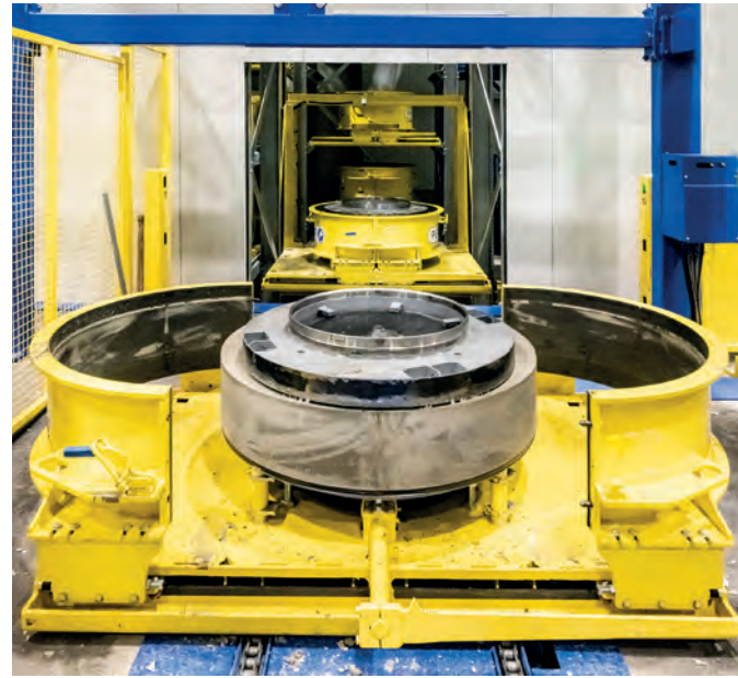
Формы одна за другой перемещаются с многоярусного стеллажного склада
