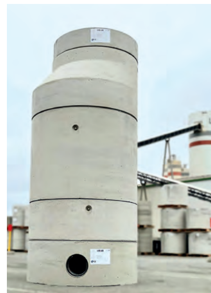
Кольца колодцев, изготовленные методом вибролитья
