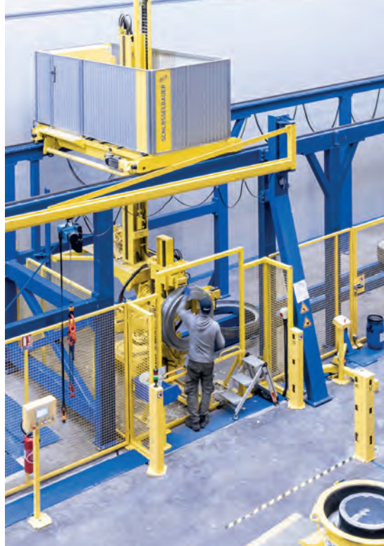
Верхние муфты автоматически перемещаются на эргономичную станцию для очистки
