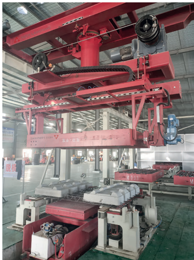
Fig. 5: Sistema di disarmo con dispositivo voltapezzi e banco di espulsione
