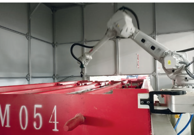
Fig. 13: Applicazione a spruzzo di disarmane supportata da robot
