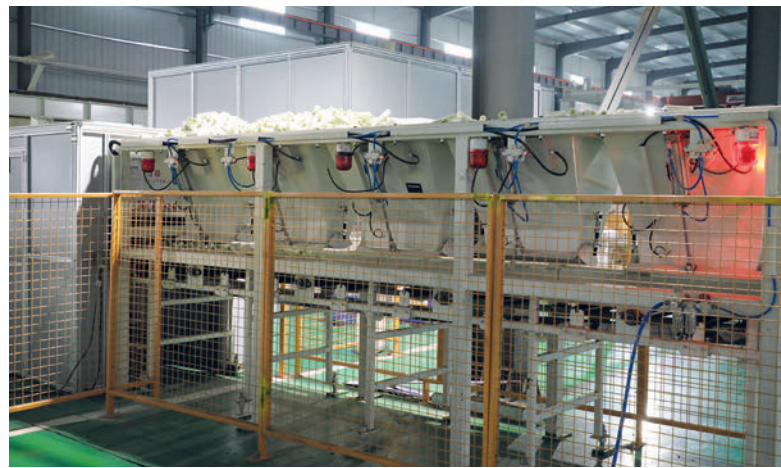
Fig. 10: Sistema di alimentazione dei bulloni di ancoraggio per il montaggio automatizzato supportato da robot
