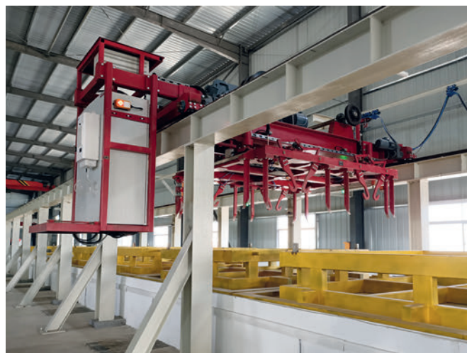
Fig. 4: Impilatore stampi per la movimentazione degli stampi e coperture delle camere di stagionatura
