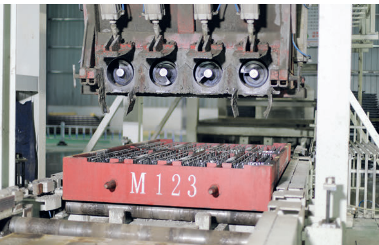
Fig. 3: Stazione automatizzata di betonaggio e compattazione
