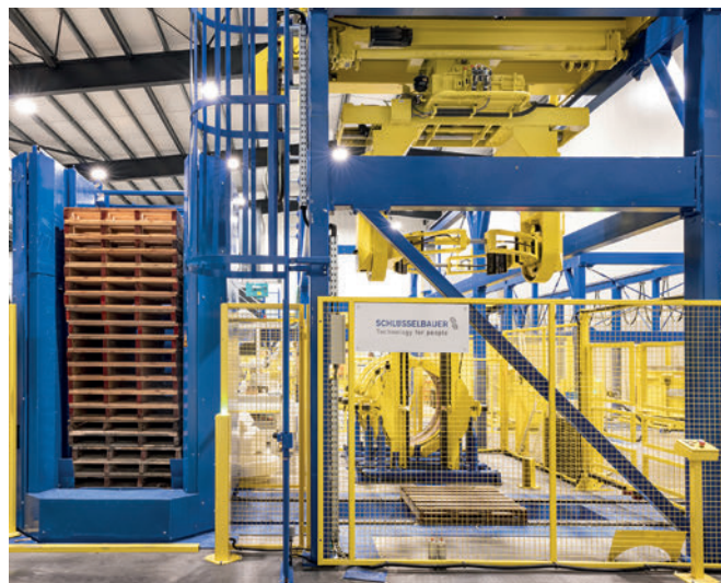
I pallet impilati vengono inseriti nel sistema
