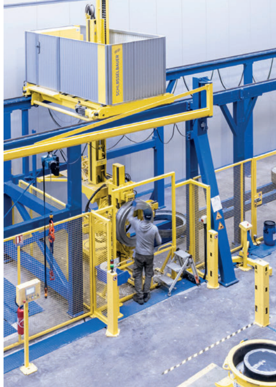
I manicotti superiori vengono spostati automaticamente e resi disponibili per la pulizia in una postazione di lavoro ergonomicamente ottimizzata.
