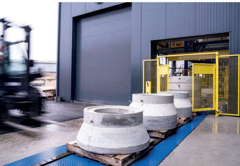
Gli elementi per pozzetti subito dopo il disarmo lasciano l'edificio pronti per essere caricati sui pallet.
