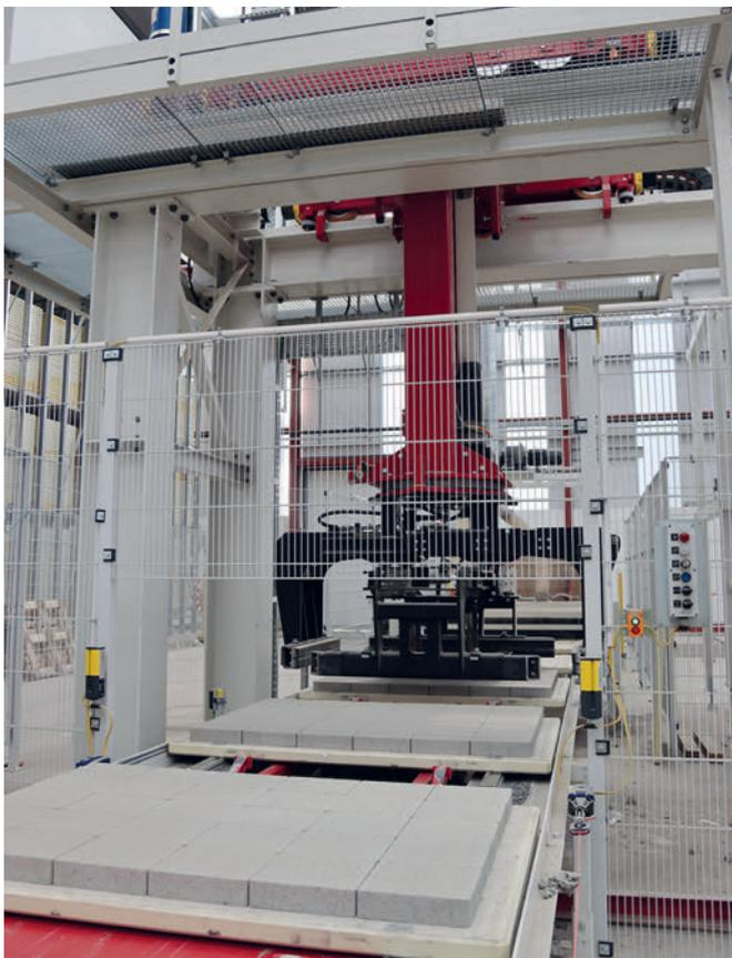
Una delle tre impacchettatrici Servo 900 di Hess nel carosello del capannone di produzione IV in Tobermore
