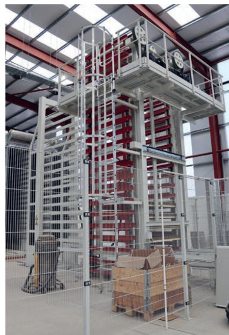
*Sia dietro il sollevatore che dietro il discensore vi è uno scaffale di accumulo con 17 piani in doppia pila e 14 tonnellate di capacità.*
