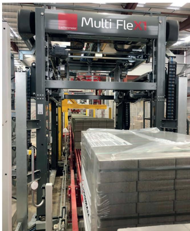
Dopo la reggiatura, una macchina Multiflex1 Stretch Hoarding del produttore Lachenmeier riveste i pacchi di blocchi stabilizzati con il film estensibile.
