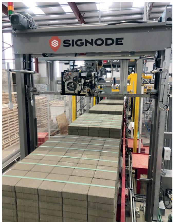
La reggiatura viene effettuata su una macchina TSM-H6500 con Jumbo Reel Dispenser e accessorio HSM-H3000 di Signode.
