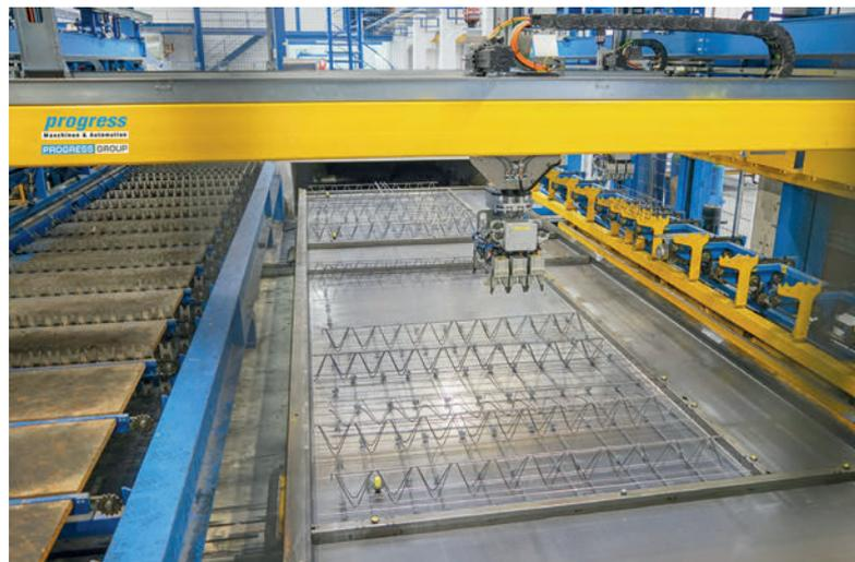
Il Wire Center posiziona l'armatura trasversale con e senza distanziatori nonché l'armatura longitudinale e i tralicci secondo le specifiche CAD.
