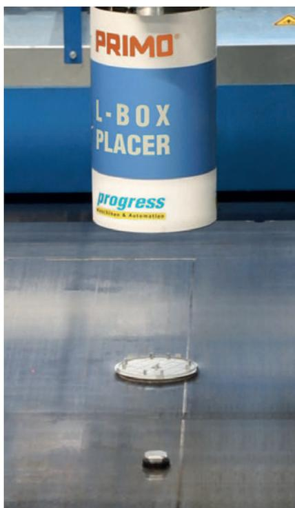
*Il dispositivo, messo a punto appositamente per Schwörer, posiziona i magneti e pannelli in fibra minerale per gli elementi integrati elettrici.*
