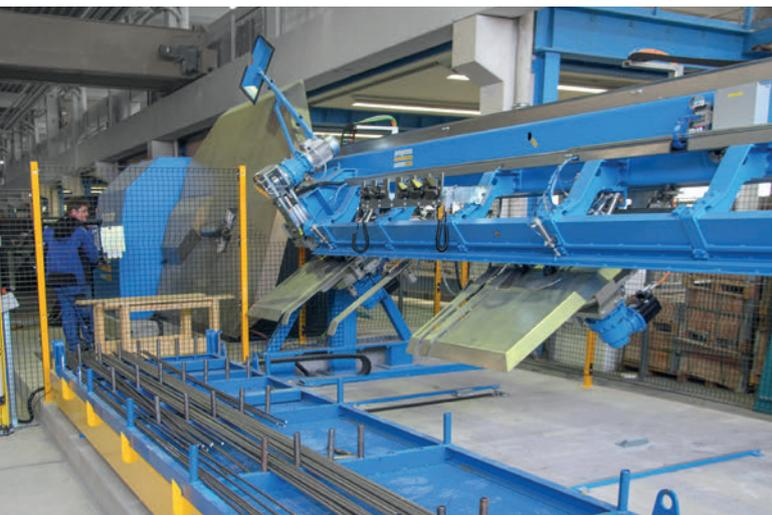
In funzione da Schwörer Bausysteme GmbH dall'inizio del 2021: Pluristar, una macchina multifunzione per tutte le fasi nella lavorazione dell'acciaio dal coil.
