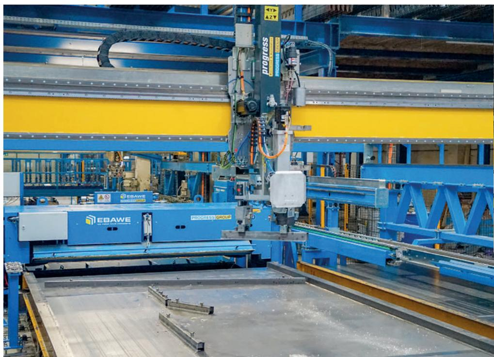
*Il robot di cassetta preleva in modo completamente automatico i casseri prima che il pallet venga fatto procedere al dispositivo di pulizia.*
