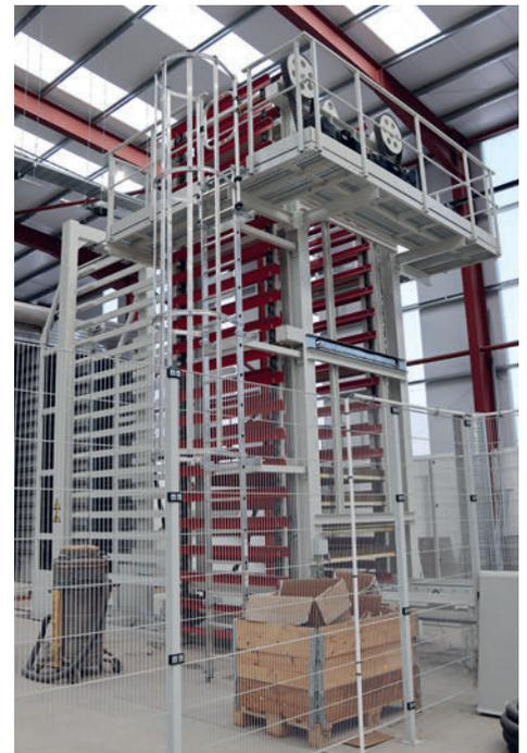
Derrière l'ascenseur et le descenseur, il y a un rayonnage tampon de 17 étages en double pile et d'une capacité de 14 tonnes chacun.
