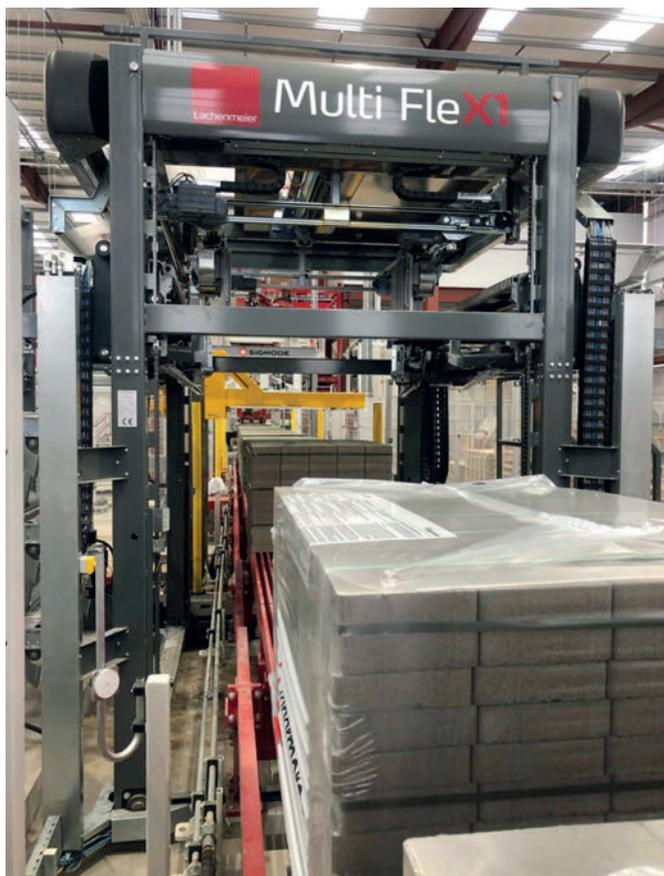
Après le cerclage, une machine Multiflex1 Stretch Hooding du fabricant Lachenmeier couvre les paquets avec une housse extensible.
