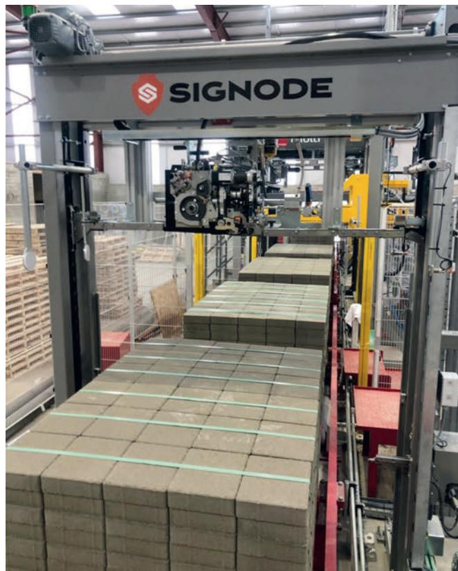
Le cerclage est effectué sur une machine TSM-H6500 avec un dérouleur Jumbo et un adaptateur HSM-H3000 du fabricant Signode.
