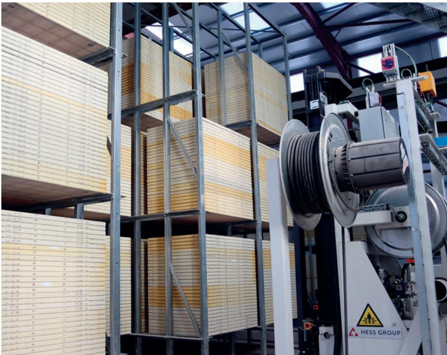
Le tampon des planches au début du côté humide contient 3 240 planches de support.
