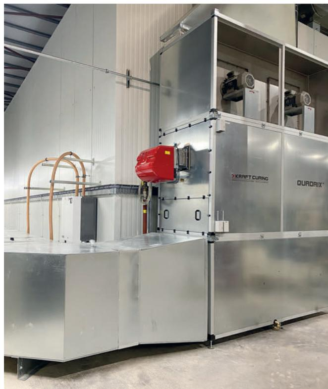
Le système de durcissement du béton Quadrix Ultra de Kraft Curing Systems assure un climat idéal dans les chambres individuelles de la chambre de durcissement.
