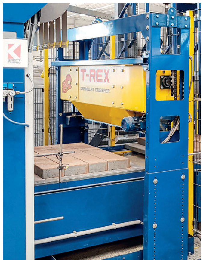
Des barrières lumineuses détectent les produits et déclenchent le processus de dosage.
