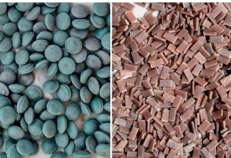
Deux types de granulés disponibles sur le marché: des pastilles ou des flocons, fabriqués à partir de plastiques recyclés.
