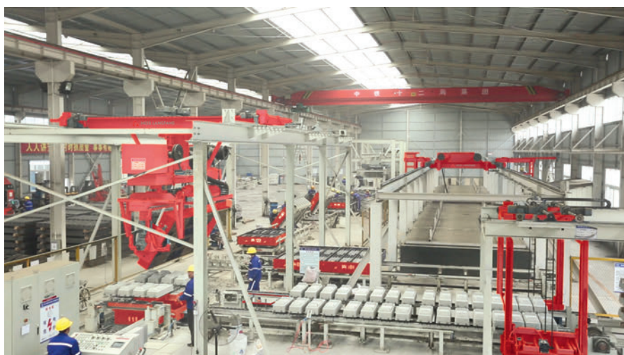
Fig. 2: Système moderne à circuit de palettisation, pour le premier projet du China Railway 12 th Bureau, ville de Lanxin Daban
