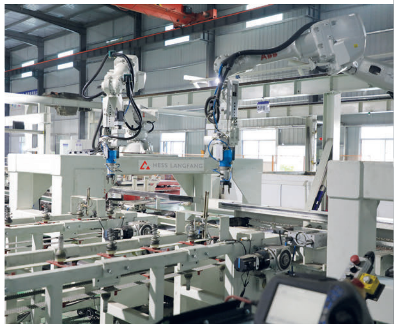
Fig. 9 : Vissage robotisé des attaches élastiques dans le moule (entièrement automatisé)
