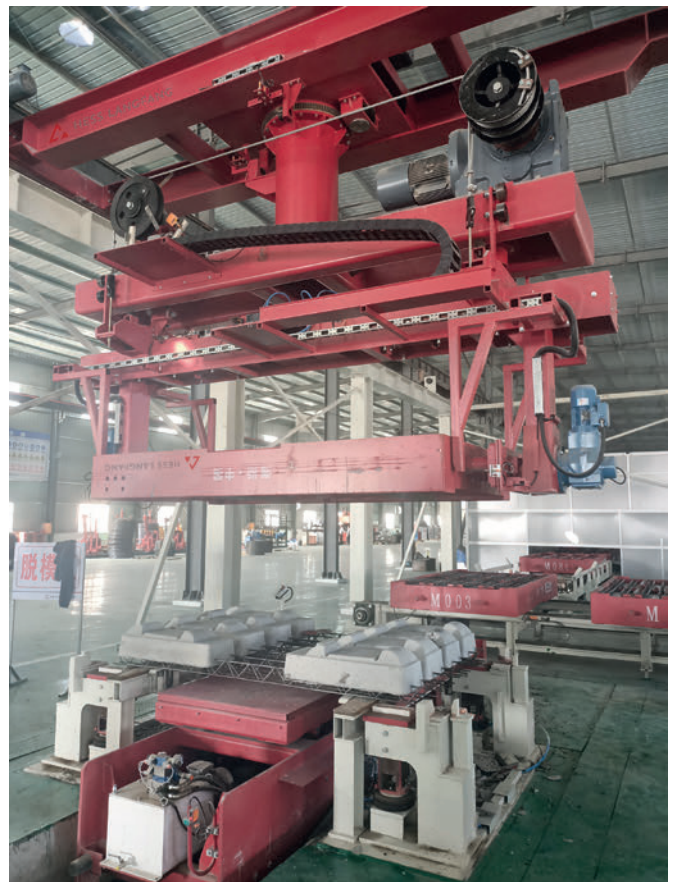
Fig. 5: Système de décoffrage avec dispositif de retournement du moule et table de décoffrage à secousses verticales
