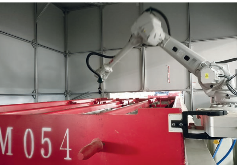
Fig. 13: Système robotisé de pulvérisation de l'agent séparateur
