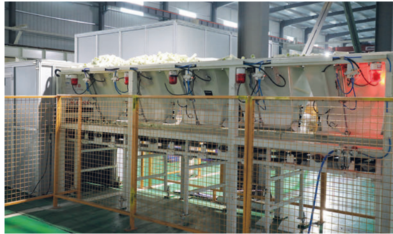
Fig. 10: Système d'alimentation pour le positionnement automatique des éléments d'ancrage
