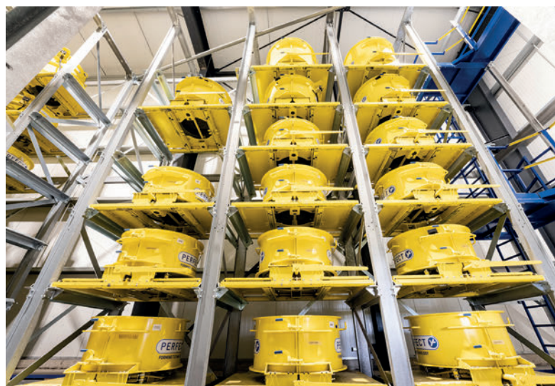
Une manière efficace de stocker les produits pour la phase de séchage dans les moules, en profitant de la chaleur dégagée par le béton
