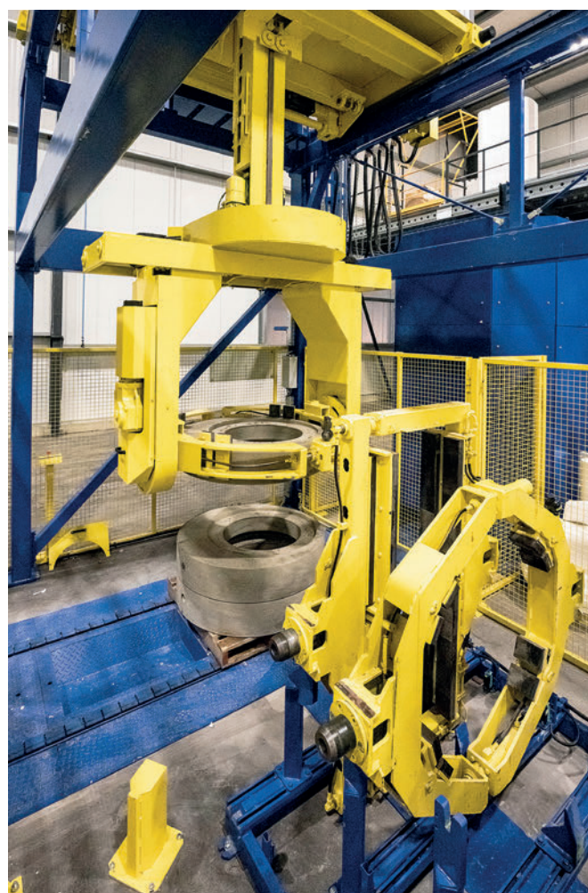
Démoulage tout en ménagement grâce à la pince-produits automatisée
