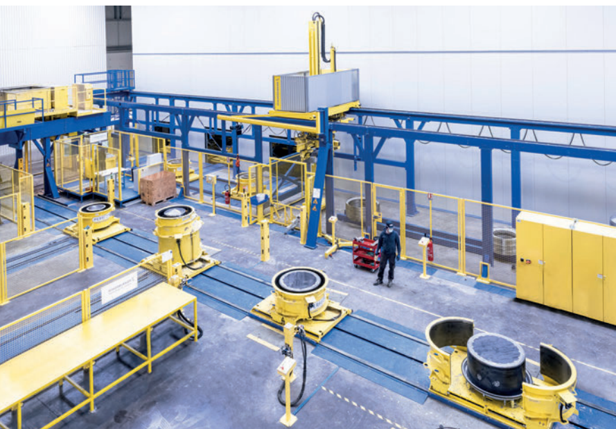
Production industrielle : chaque moule sur la ligne avance en cadence vers la zone de coulage, indépendamment du degré de préparation requis
