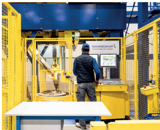
Le poste de pilotage central permet de surveiller en même temps le coulage ainsi que les entrées et sorties des rayonnages
