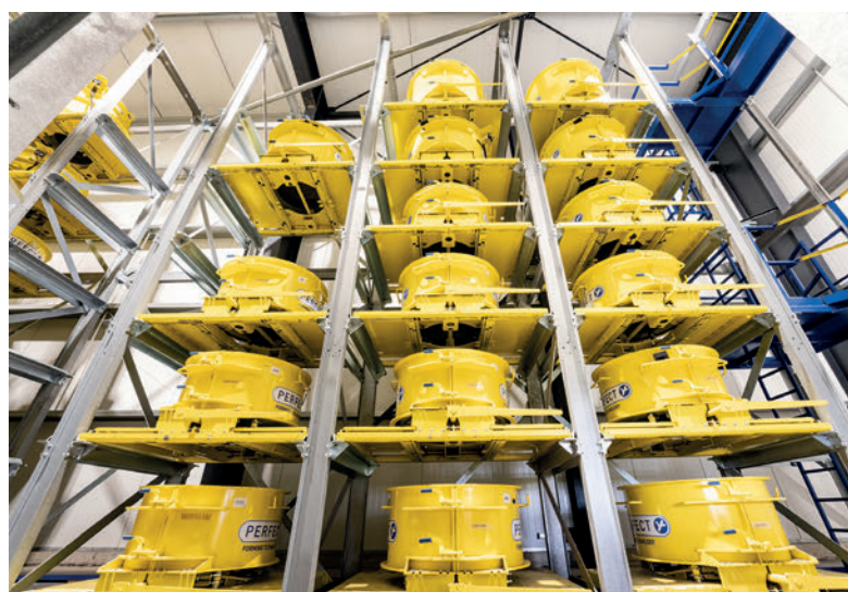
Se trata de un modo eficiente de almacenar el producto endurecido en encofrado y de aprovechar la energía del hormigón que se está endureciendo.
