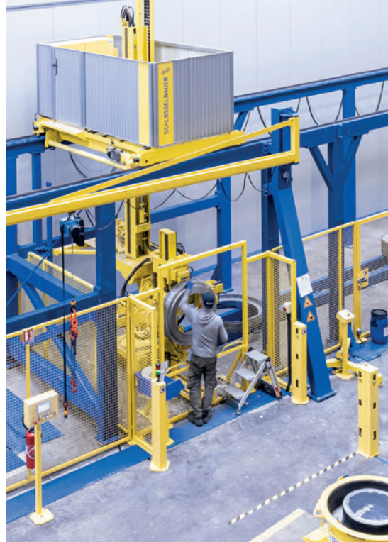
Los manguitos superiores se desplazan de forma automática y se disponen en un puesto de trabajo optimizado ergonómicamente para la limpieza.
