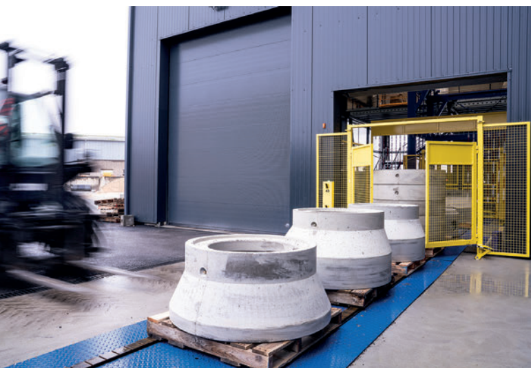
Los componentes para pozos que se acaban de desencofrar abandonan el edificio sobre palés, ya preparados para su carga.
