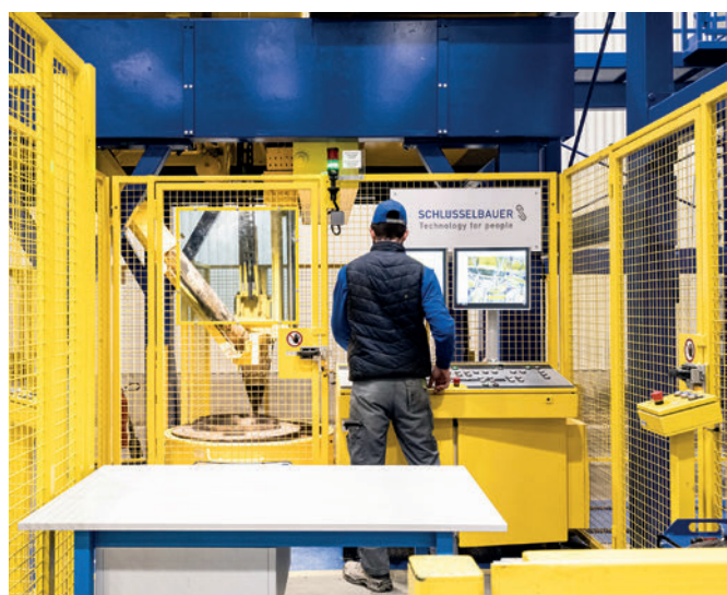
Tanto el proceso de llenado como el almacenamiento y la retirada de moldes del almacén de estantes altos se supervisan al mismo tiempo desde un panel de mando central.
