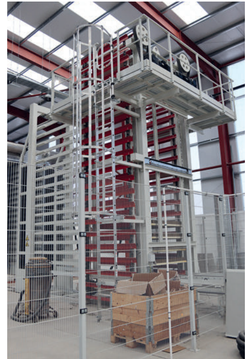
Tanto detrás del elevador como del descensor hay una estantería de almacenamiento temporal con 17 pisos dobles y una capacidad de 14 toneladas.
