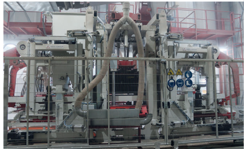
La máquina bloquera RH 1500-4 MVA de Hess es el componente principal de la producción.
