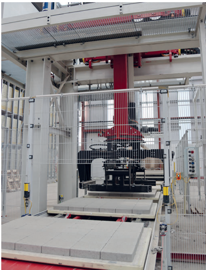
Una de las tres empaquetadoras Servo 900 de Hess en la instalación de carrusel de la nave de producción IV de Tobermore
