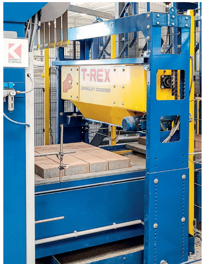
Las barreras fotoeléctricas detectan los productos e inician la dosificación
