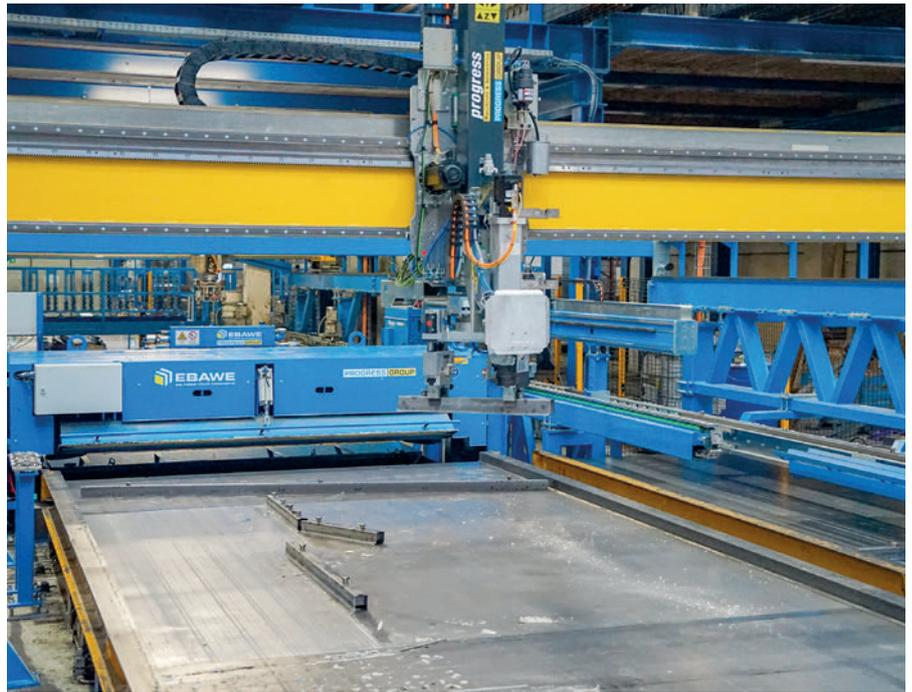
El robot de desencofrado retira los encofrados de forma completamente automática antes de que las bandejas sean derivadas al dispositivo de limpieza.
