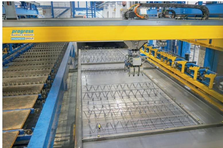
El Wire Center coloca armadura transversal con y sin separadores, así como armadura longitudinal y armadura de celosía según los datos CAD.
