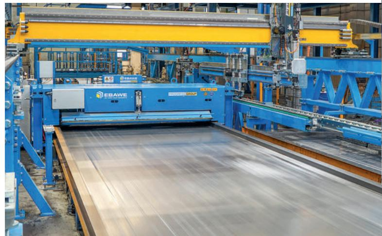
El limpiador de bandejas de Ebawe también forma parte del nuevo robot de encofrado
