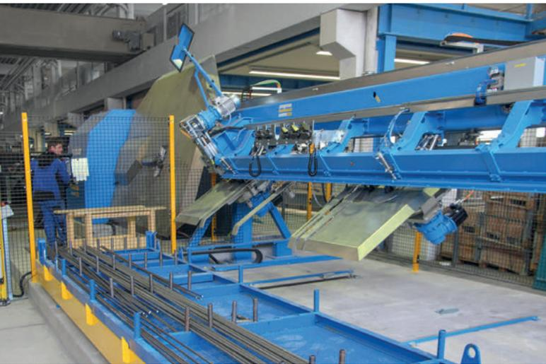
Desde comienzos de 2021 en funcionamiento en Schwörer Bausysteme GmbH: La Pluristar - Una máquina multifunción para todos los pasos en el procesamiento de acero desde la bobina.
