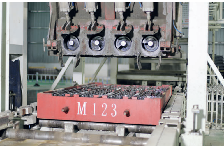
Fig. 3: Estación de hormigonado y compactación automática
