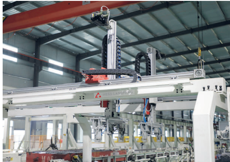
Fig. 8: Colocación automatizada de la armadura de acero en la producción de traviesas
