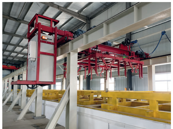
Fig. 4: Dispositivo de apilado de moldes para manipular los moldes y las cubiertas de la cámara de curado
