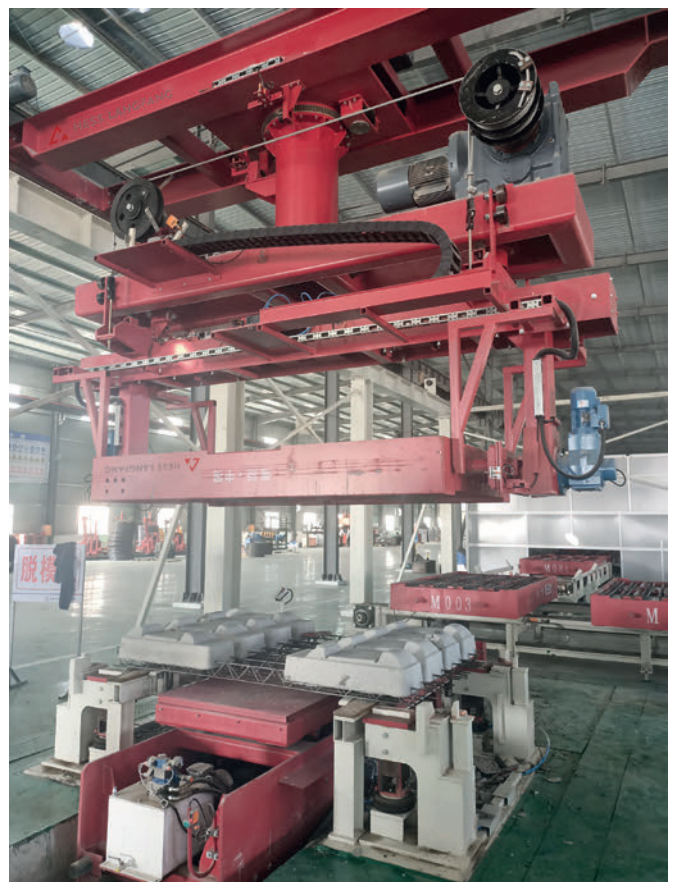
Fig. 5: Sistema de desencofrado con dispositivo de volteo de moldes y mesa de sacudidas
