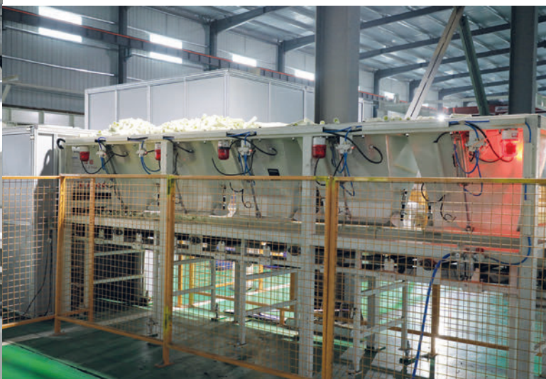
Fig. 10: Sistema de entrega de anclajes roscados al montaje automatizado con robot
