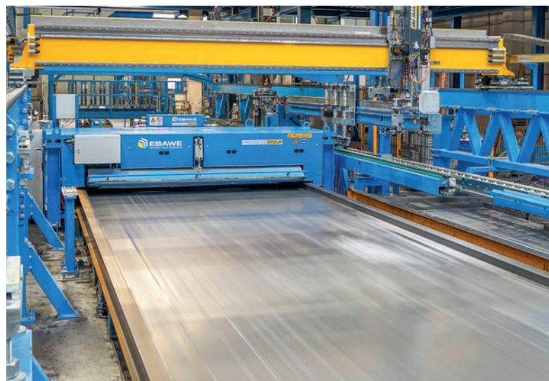
Der Palettenreiniger von EbaWE ist ebenfalls Bestandteil des neuen Schalungsroboters.
