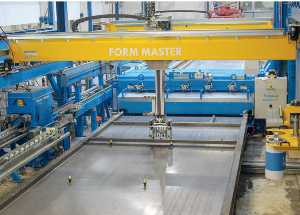
Der individualisierte Schalungsroboter bei Schwörer platziert die Schalungen, Magnete und Montagehülsen passgenau auf der Palette.
