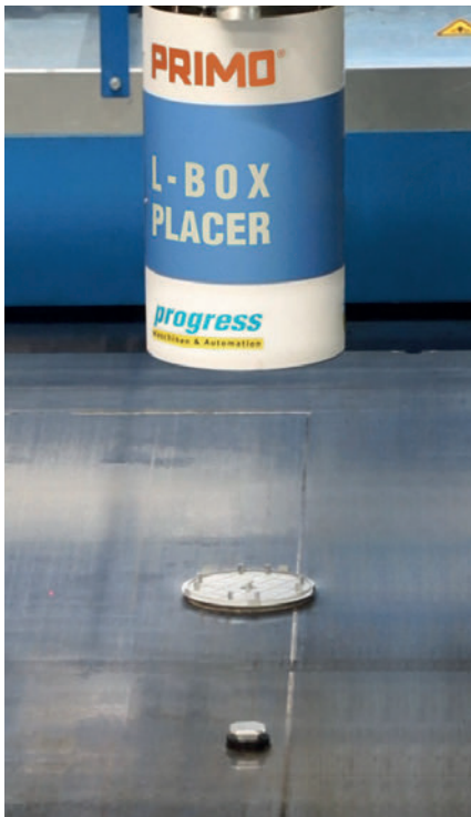
Die speziell für Schwörer entwickelte Vorrichtung setzt Primo-Magnete und Primo-Mineralfaserplatten für Elektroeinbauten.
