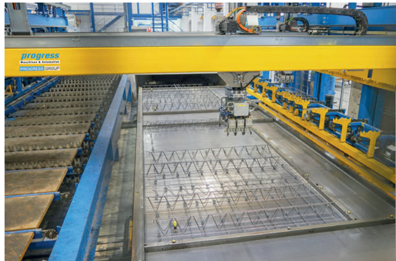
Das Wire Center verlegt Querbewehrung mit und ohne Abstandhalter sowie Längsbewehrung und Gitterträger.
