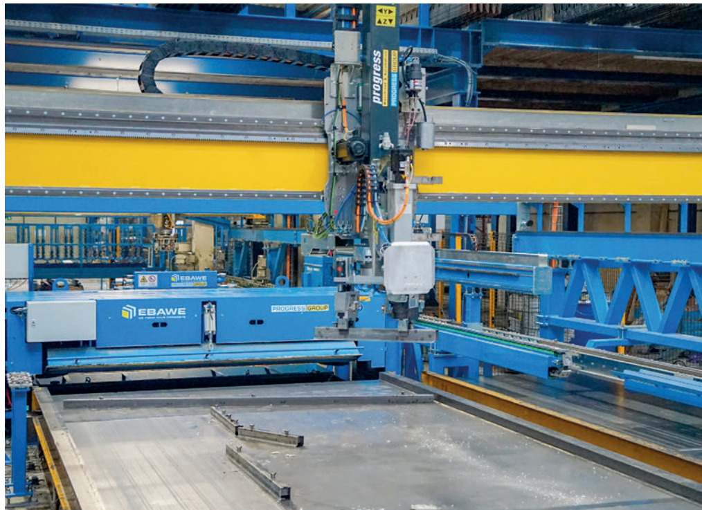
Der Entschalroboter entnimmt die Schalungen vollautomatisch, bevor die Palette in die Reinigungseinrichtung weitergeleitet wird.
