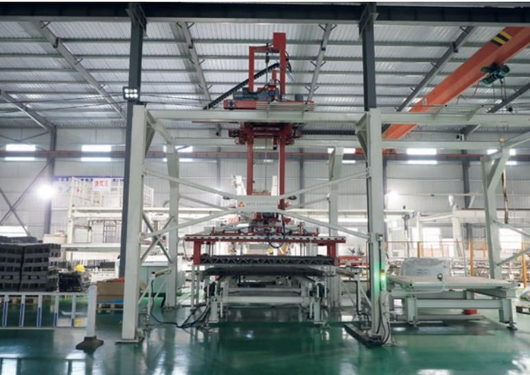
Abb. 11: Palettiersystem mit Positionssensoren für effizientes Bewehrungs-Handling
