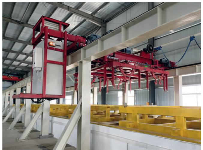
Abb. 4: Formenstapelvorrichtung zum Handling der Formen und Abdeckungen der Aushärtekammer
