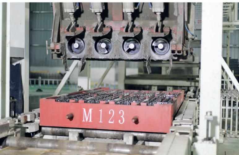
Abb. 3: Automatisierte Betonier- und Verdichtungsstation
