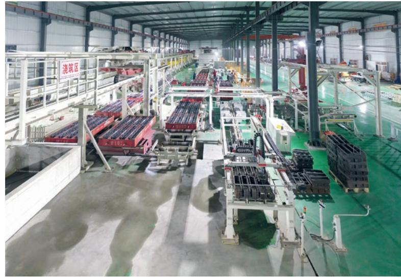
Abb. 12: Vollautomatisierte Montage von Einbauteilen/ Bewehrungsstahl
