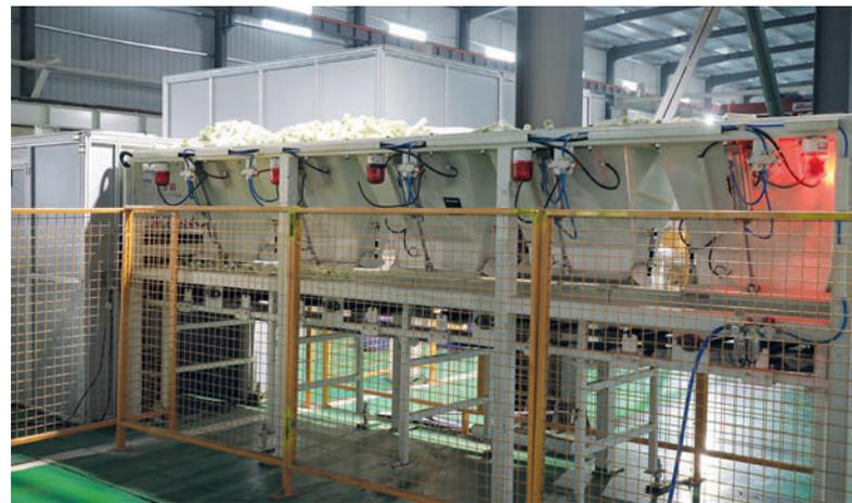
Abb. 10: Aufgabesystem für Schraubenanker zum automatisierten robotergestützten Einbau
