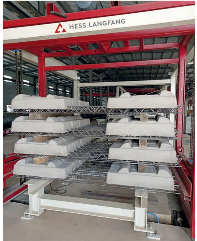
Abb. 6: Automatisierte Schwellenstapelvorrichtung
