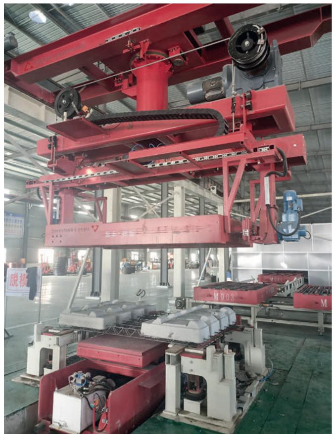
Abb. 5: Entschalssystem mit Formwendevorrichtung und Ausschlagstisch
