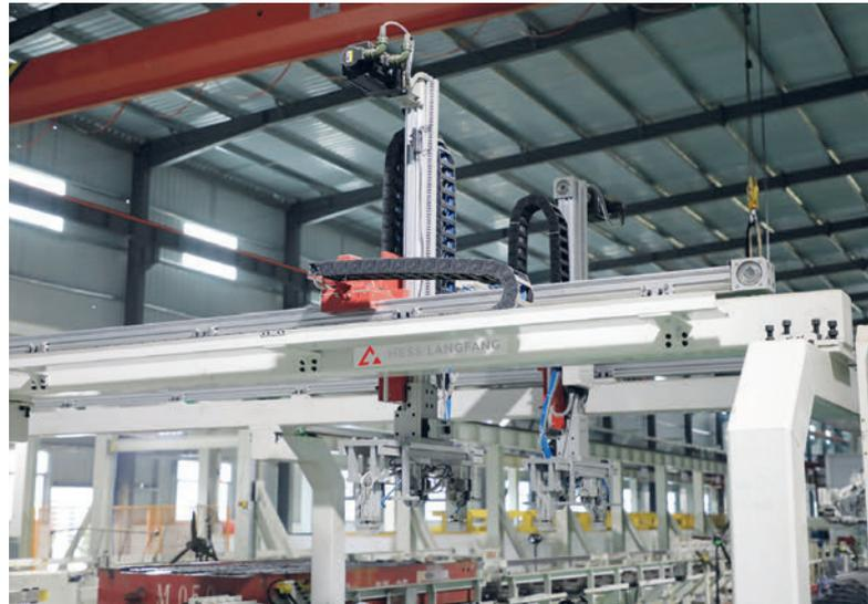
Abb. 8: Automatisierter Einbau von Betonstahlbewehrung bei der Schwellenproduktion
