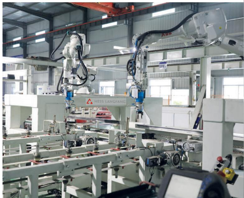
Abb. 9: Robotergestütztes Einschrauben von Federelementen in die Form - vollautomatisiert
