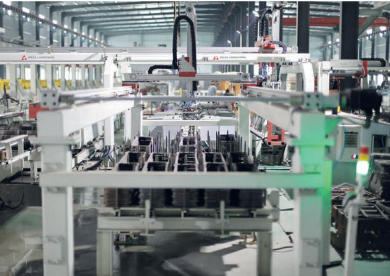
Abb. 7: Automatisierter Zusammenbau der Betonstahlbewehrung bei der Schwellenproduktion
