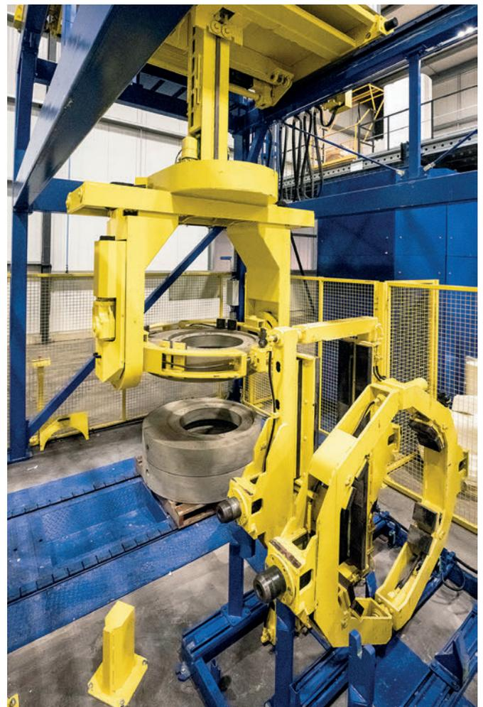
Der automatische Produktmanipulator entnimmt die Produkte schonend aus den Formen.
