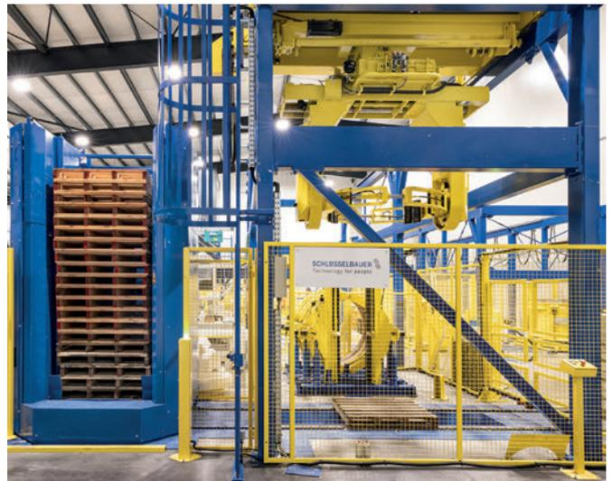
Stapelweise werden die Paletten dem System zugeführt.
