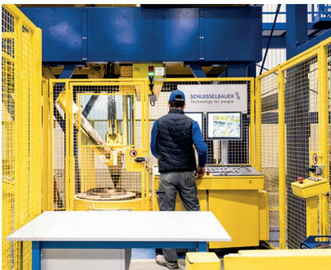
Von einem zentralen Bedienpult aus werden gleichzeitig der Befüllvorgang sowie das Ein- und Auslagern der Formen in den Hochregallagern überwacht.
