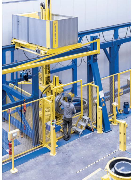
Obermuffen werden automatisch bewegt und an einem ergonomisch optimierten Arbeitsplatz zur Reinigung bereitgestellt.
