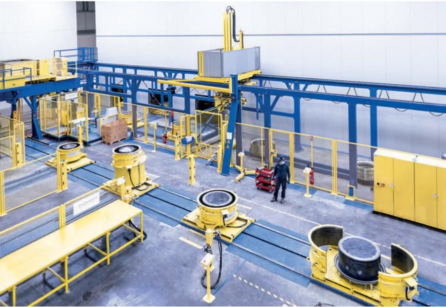
Industrielle Fertigung: Unabhängig vom erforderlichen Rüstaufwand wird jede Form auf der Fertigungslinie im Arbeitstakt zum Füllbereich befördert.
