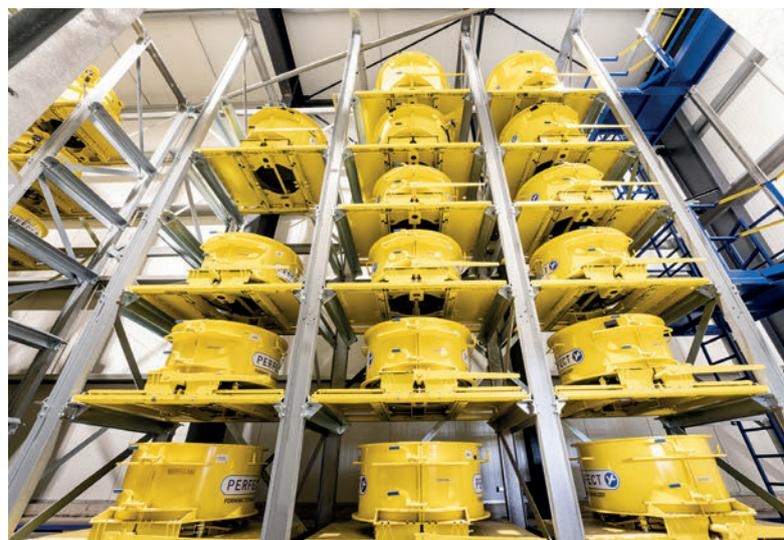
Eine effiziente Weise, das Produkt in schalungserhärterter Fertigung einzulagern und dabei die Energie des erhärtenden Betons zu nutzen.
