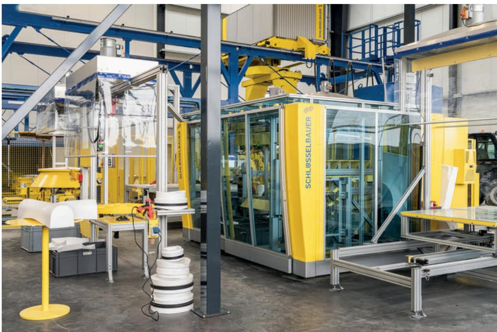
*Ein Herzstück des Perfect-Fertigungssystems ist die Heißdrahtsäge-Anlage zur Fertigung passgenauer individueller Gerinne.*
