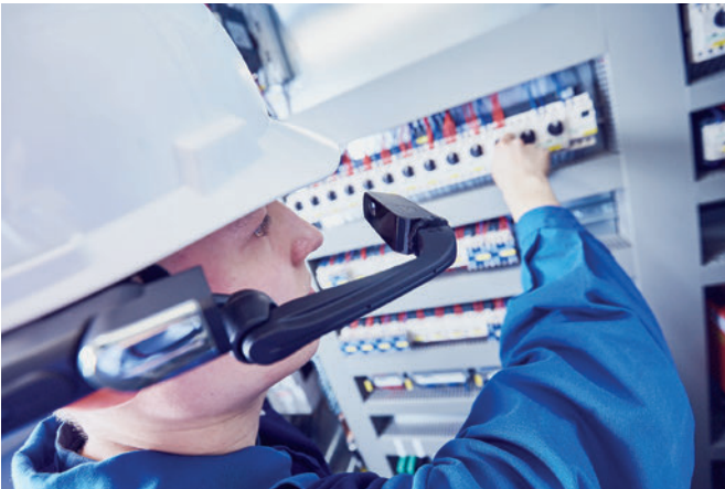
Masa Smart Glasses: Head-up-Display mit Kamera
